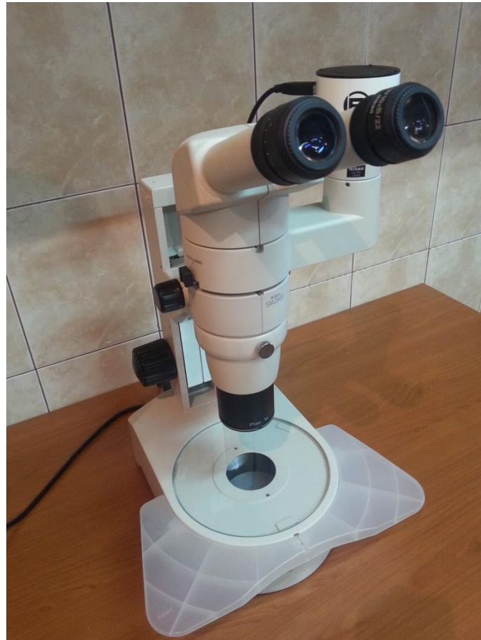
Слика 6. Бинокуларна лупа, модел Nikon SMZ 800 (фото: М. Раденковић)
