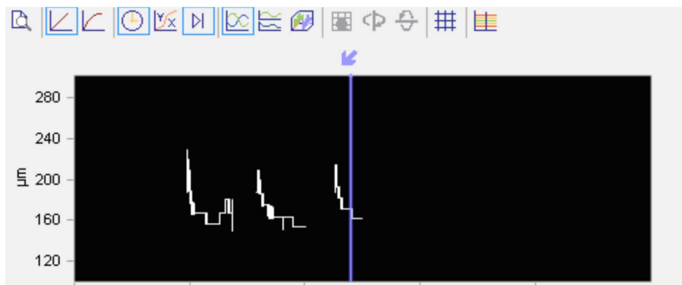
Slika 6.40. Položaj rukavca rotora mereno na L1 po y-pravcu
