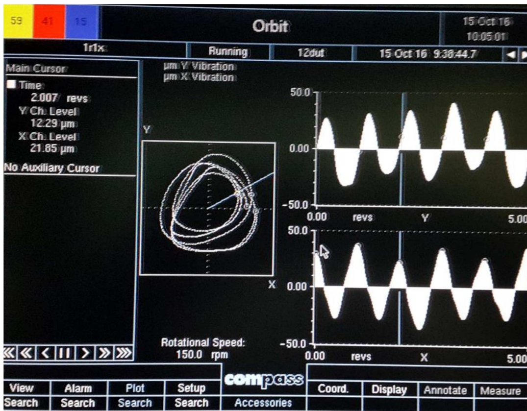
Slika 6.42. Prikaz orbite rotornih vibracija sa L1
