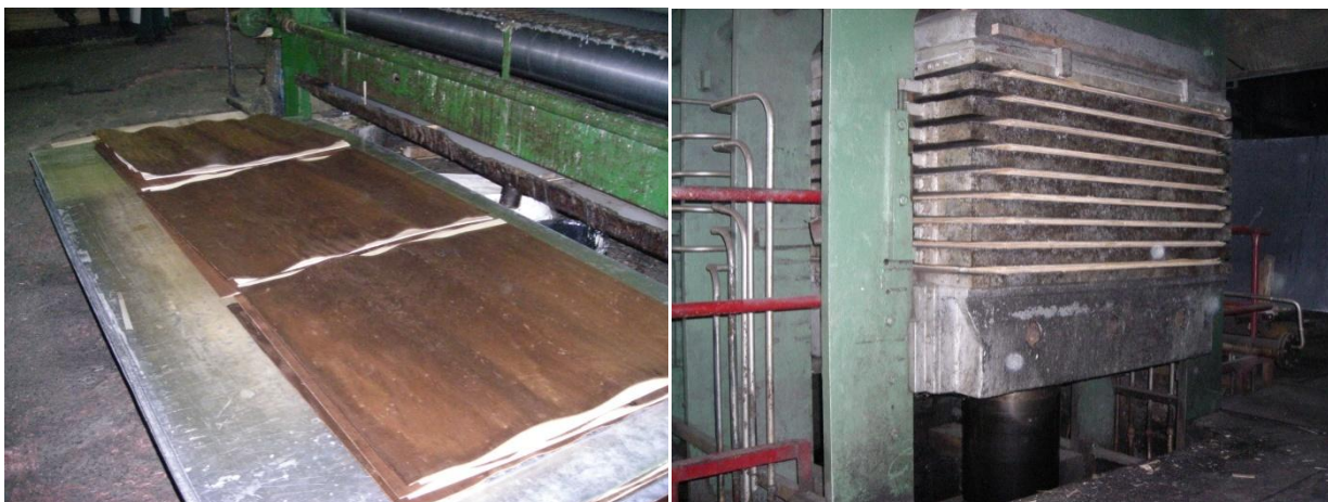
Slika 28. Priprema za presovanje (levo) i presovanje ploča (desno)
