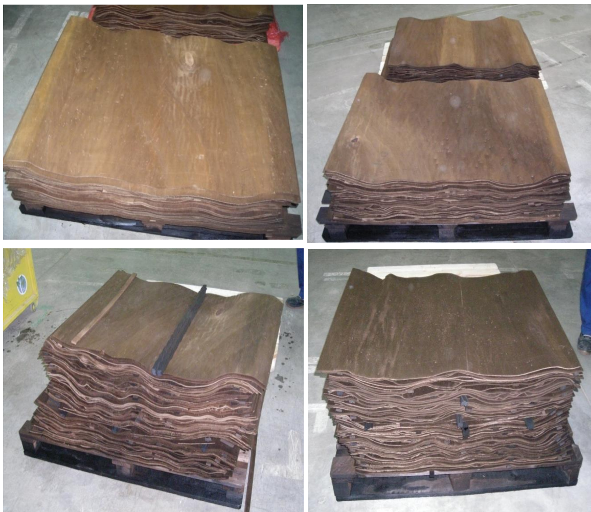
Slika 24. Izgled topolovog furnira posle termičke modifikacije. Tretman na 190 °C (gore levo); Tretman na 200 °C (gore desno); Tretman na 210 °C (dole levo); Tretman na 215 °C (dole desno)
