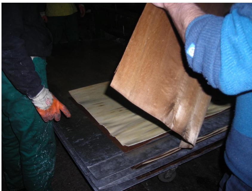
Slika 27. Formiranje “sendviča” za presovanje
