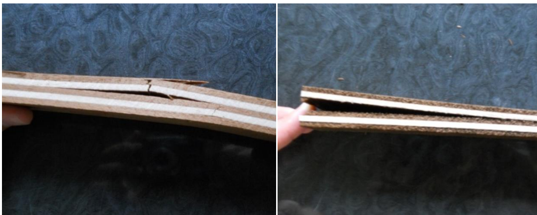
Slika 49. Izgled loma pojedinih epruveta TNTNT ploča, pri ispitivanju savojne čvrstoće
