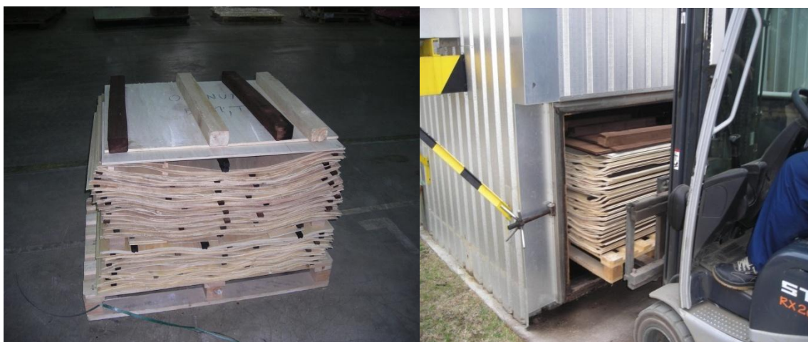
Slika 22. Priprema topolovog furnira za termičku modifikaciju (levo) i ubacivanje pripremljenog furnira u laboratorijsku komoru (desno)
