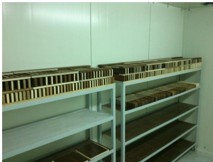
Slika 31. Kondicioniranje epruveta u klima komori firme “Tarkett”
