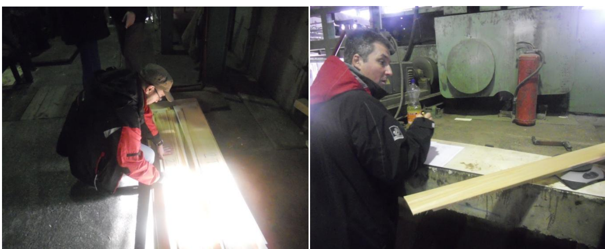
Slika 20. Obeležavanje (levo) i merenje (desno) uzoraka furnira za određivanje vlažnosti
