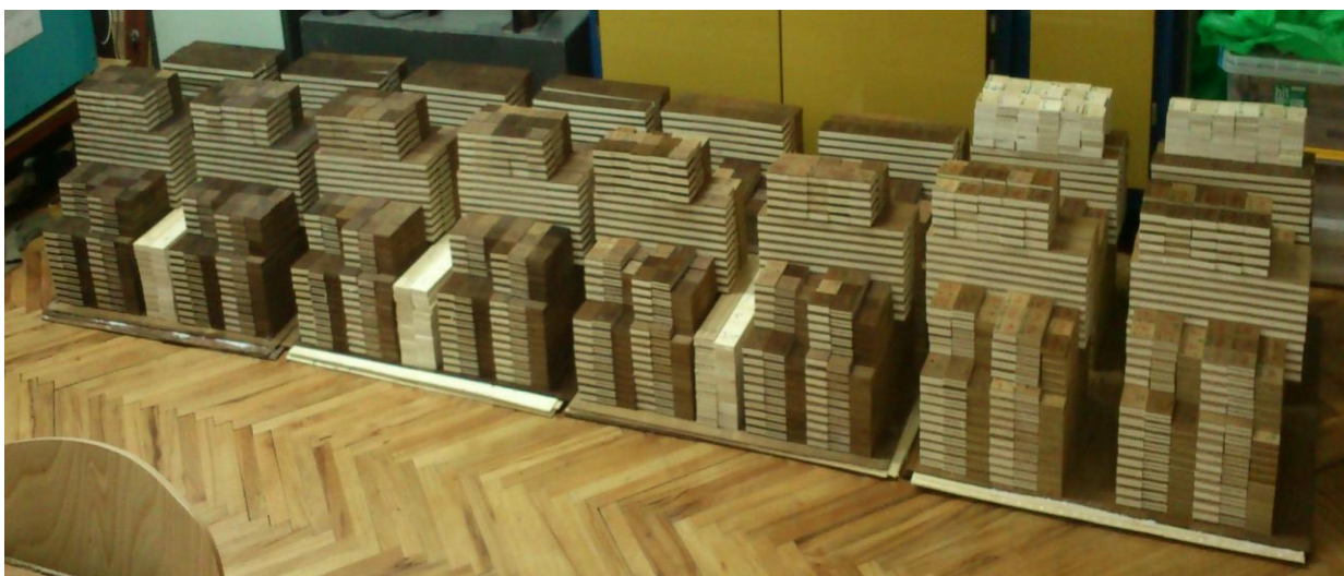
Slika 30. Izradene epruvete za ispitivanje fizičkih i mehaničkih svojstava
