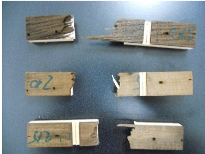
Slika 35. Primeri epruveta koje su pukle van ispitivane zone
