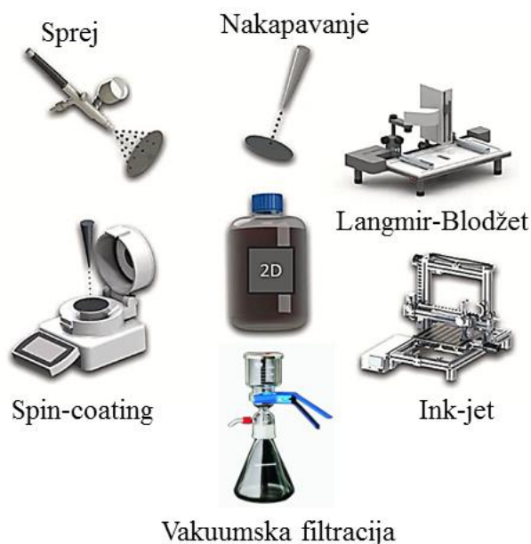
Slika 10. Šematski prikaz različitih metoda depozicije 2D materijala. Slika adaptirana sa dozvolom iz ref. [73]. Copyright © 2019 Wiley, S. Witomska et al., Production and Patterning of Liquid Phase-Exfoliated 2D, Sheets for Applications in Optoelectronics , Adv. Funct. Mater., John Wiley and Sons.
