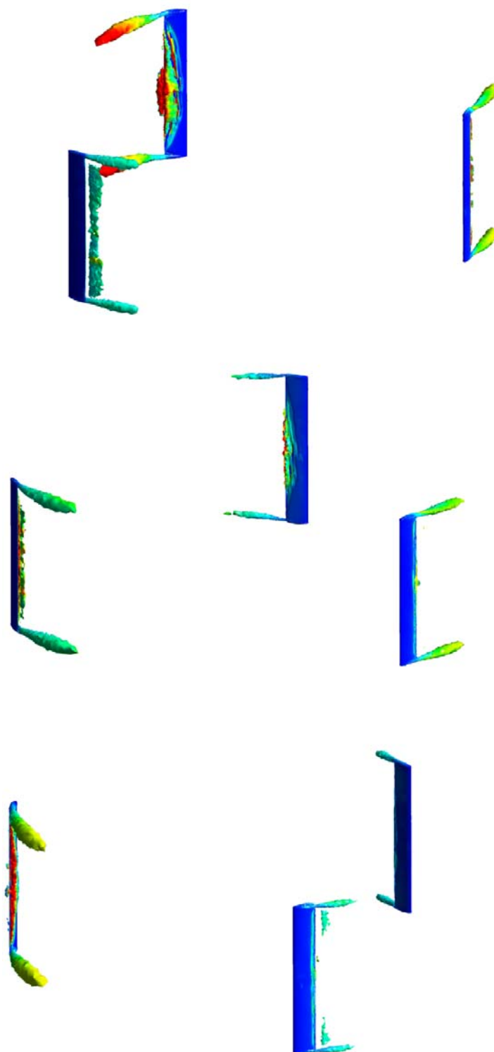
Слика 3.22. Вртложне структуре око ротора при \lambda = 2.856
