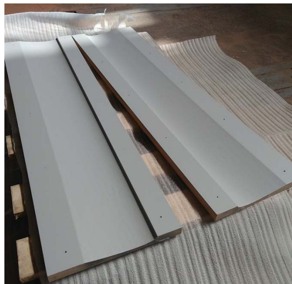
Слика 5.6 Завршене половине калуца
