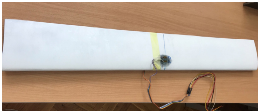
Слика 5.12 Позиција мерних трака на лопатици
