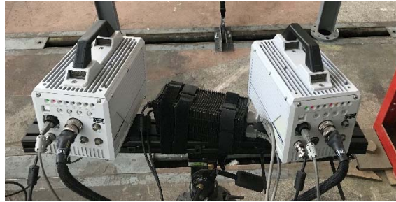
Слика 5.15 Коришћени 3Д DIC систем
