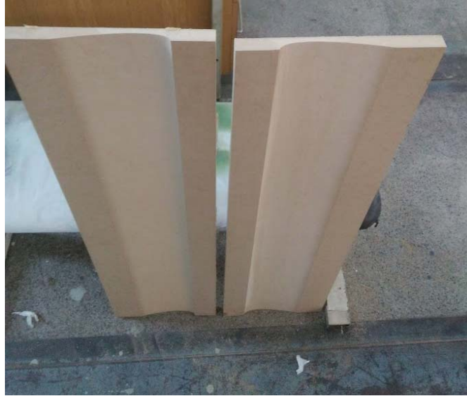
Слика 5.5 Два израдка половине калуца
