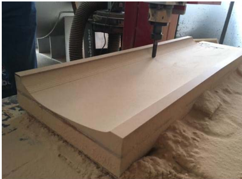
Слика 5.4 Поступак fine обраде половине калупа лопатице
