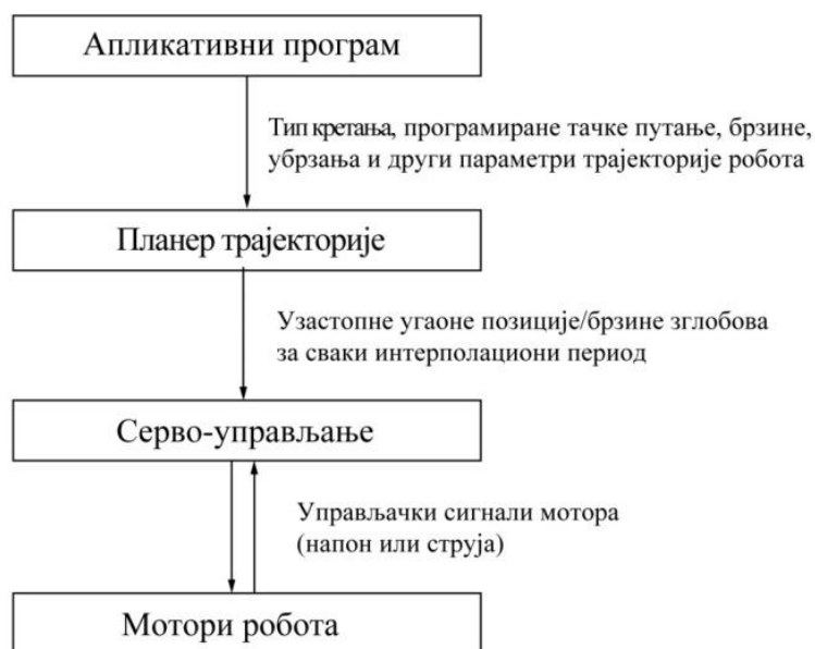
Слика 2.9. Проток информација у роботском систему [28]
