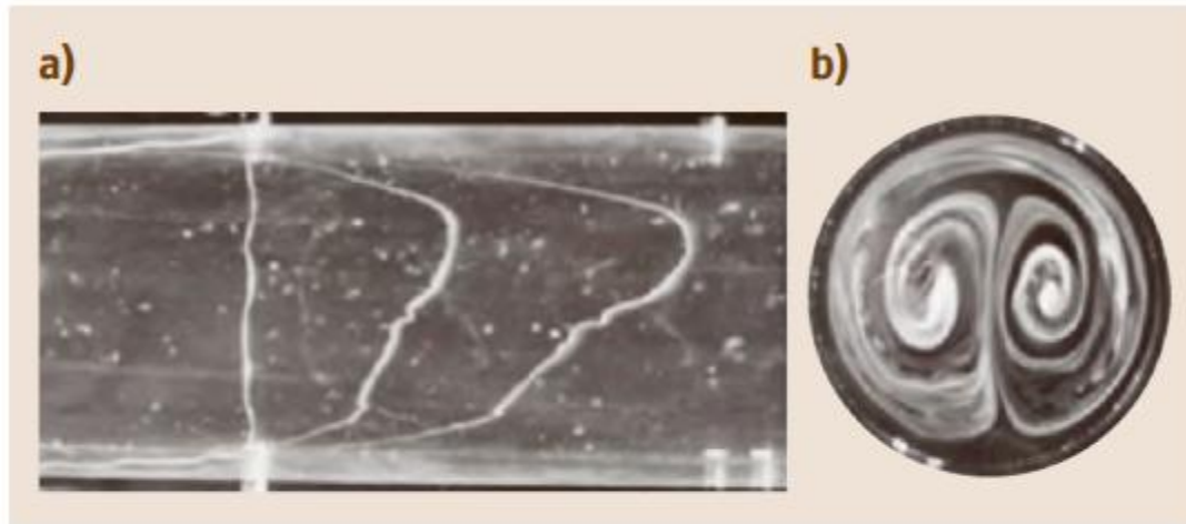
Слика 20. Визуелизација Динових вртлога методом “smoke wire” [27]
