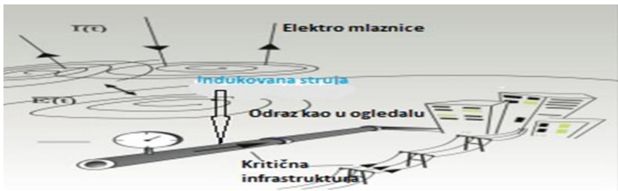
Slika br.9 Uticaj Geomagnetski indukovane struje na kritične infrastrukture, izvor [4].
