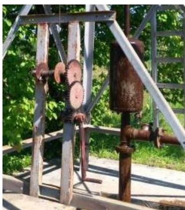
Slika 18. Vitlo sa sajlom za regulaciju brzine i jednocilindrična pumpa za vodu
