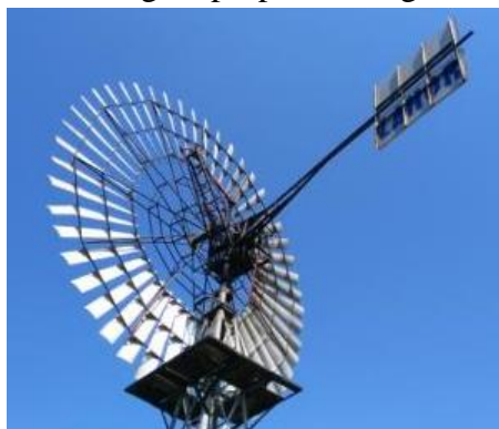
Slika 17. Izgled propelera i regulatora brzine
