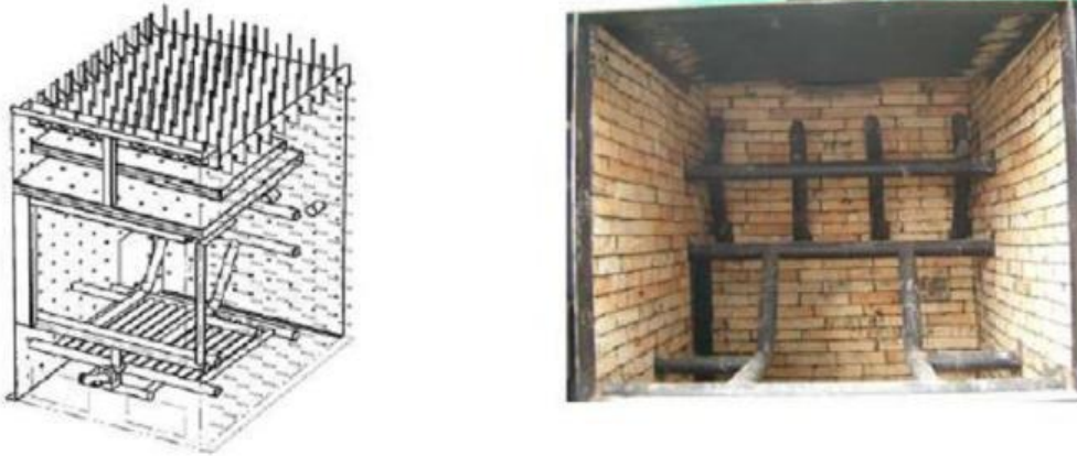
Slika 2. Dvostepena rešetka ložišta kotla termičke snage 300 kW
