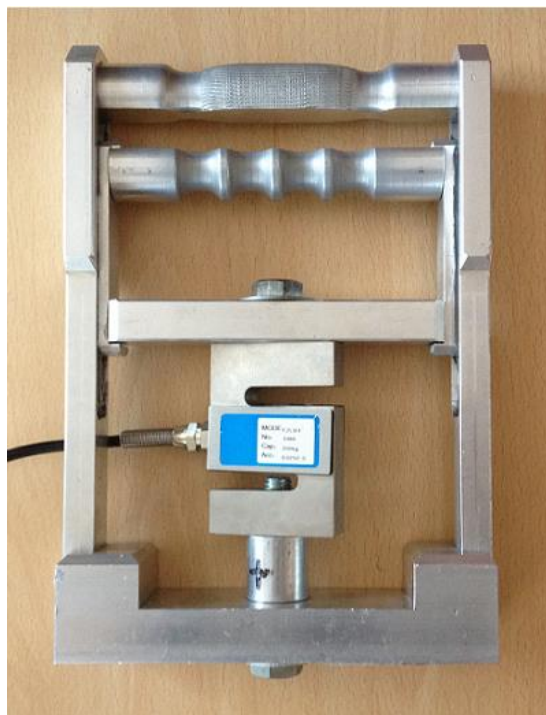
Slika 4. Dinamometrijska sonda sa konstrukcijom za test: stisak šake
