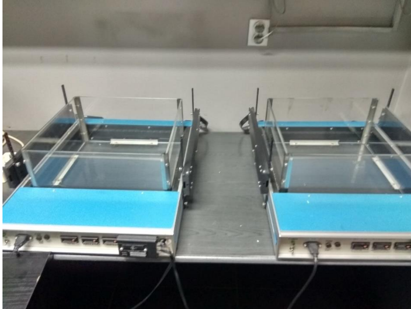
Slika 3.2. Opto Varimex kavezi za praćenje motoričke aktivnosti kod glodara (Laboratorija 56, IBISS)
