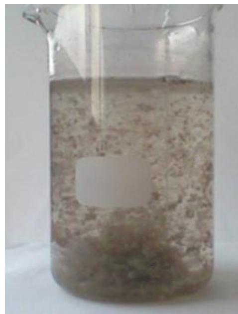
Slika 11. Izgled uzorka otpadne vode po dodatku ferata(VI), koagulacija i obrazovanje flokula
