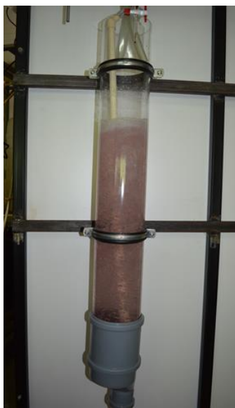
Slika 14 Tretman sirove vode opterećene As(V), feratom(VI) uz aeraciju
