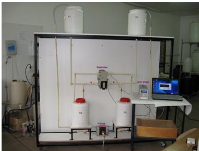
Slika 3 Izgled prenosnog uređaja za elektrohemijsku sintezu ferata(VI)
