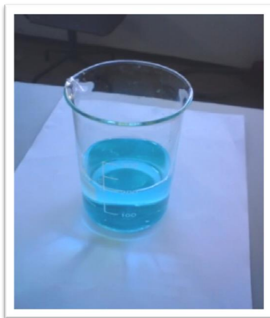
Slika 6. Uzorak otpadne vode iz procesa elektrolitičke rafinacije bakra pre tretmana rastvorom NaOH i Na 2 FeO 4
