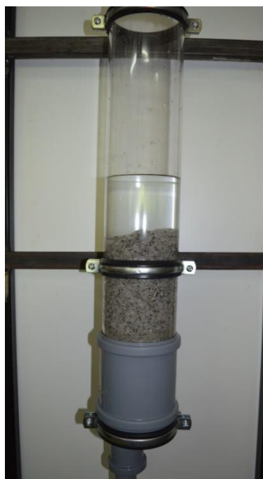
Slika 17 Filtracija tretirane sirove vode sa filtracionim peskom različitog granulata
