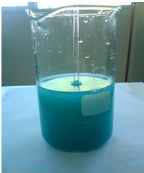
Slika 7. Izgled uzorka otpadne vode iz procesa elektrolitičke rafinacije bakra posle dodatka 6 ml 10 M NaOH
