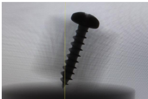
Slika 5.4 Prozračen deo prilikom postavke prikazan u softveru CT Pro 3D
