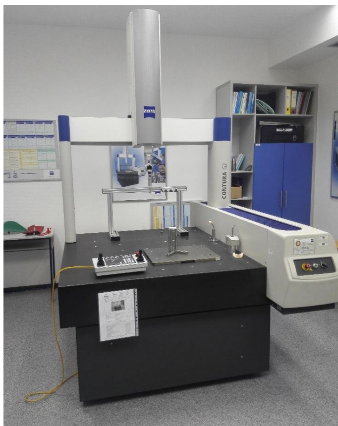
Slika 3.7 Koordinatna merna mašina CARL ZEISS CONTURA G2 na Fakultetu tehničkih nauka
