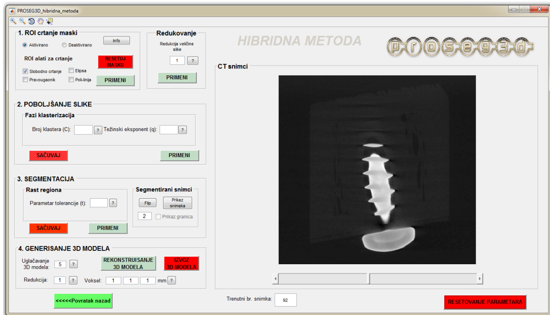
Slika 4.14 Grafički prikaz dijalog okvira za segmentaciju CT snimaka primenom hibridne metode
