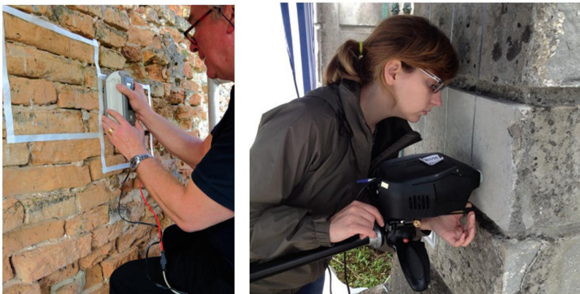
Slika 4 - In situ kolorimetrijska i XRF ispitivanja mobilnom laboratorijom, projekat HEROMAT
