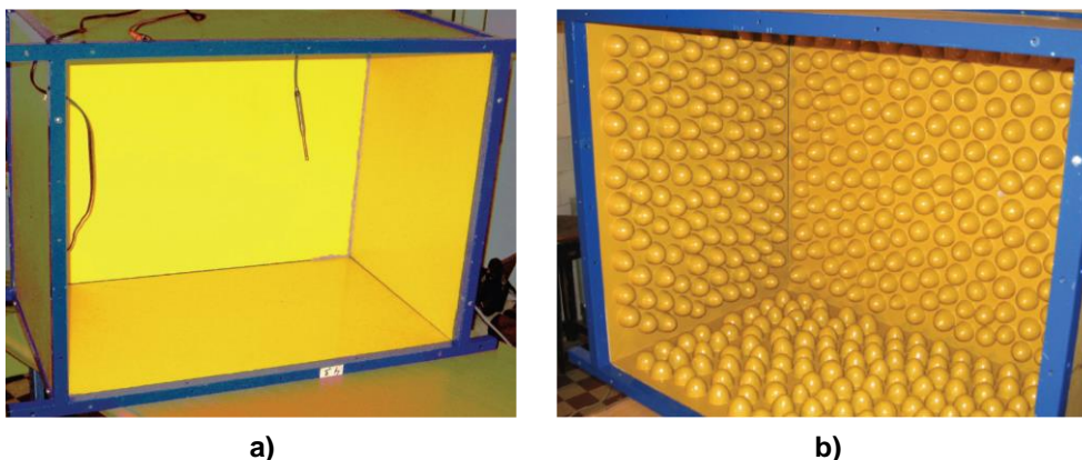
Slika 6.1. Prikaz fizičkog modela različite difuznosti: a) sa ravnim stranama; b) sa difuznim stranama
