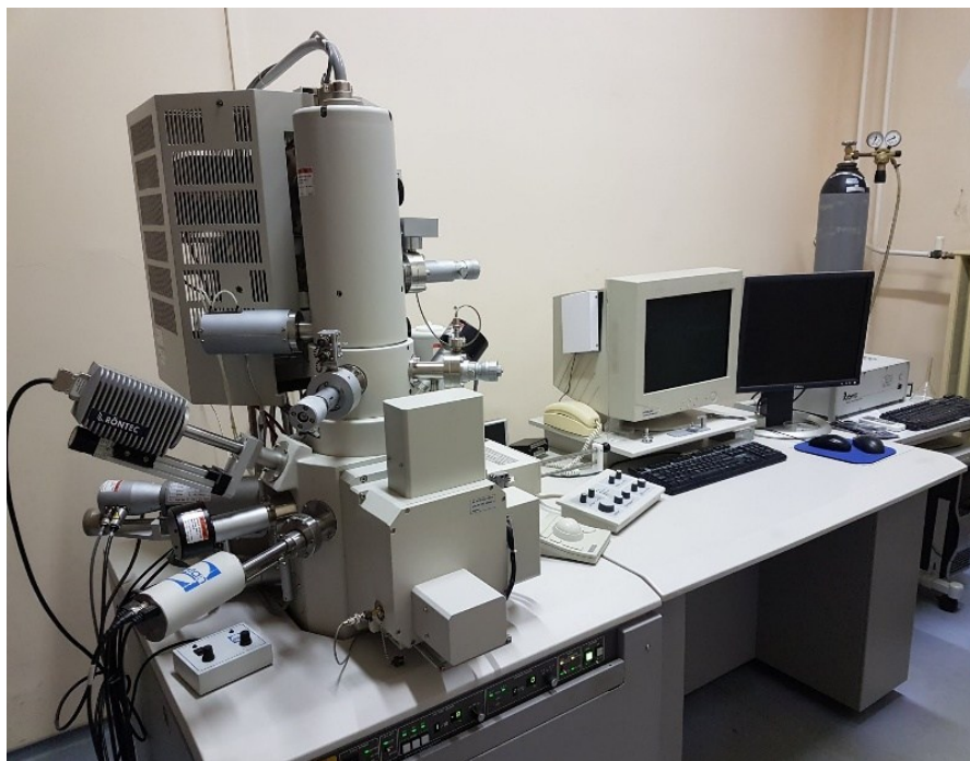
Slika 16. HITACHI S-4700 Tip II skenirajući elektronski mikroskop (Laboratorija departmana za primenjenu i hemiju životne sredine, Univerzitet u Segedinu).
