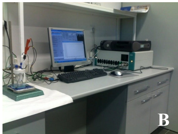
Slika 14. Autolab elektrohemijски analizator koji je povezan sa GPES 4.9 softverom: A) laboratorija na PMF, Novi Sad, B) laboratorija na Hemijsko-tehnološkog fakultetu, Univerzitet u Pardubicama.
