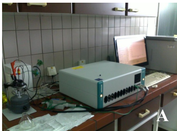
Slika 14. Autolab elektrohemijски analizator koji je povezan sa GPES 4.9 softverom: A) laboratorija na PMF, Novi Sad, B) laboratorija na Hemijsko-tehnološkog fakultetu, Univerzitet u Pardubicama.
