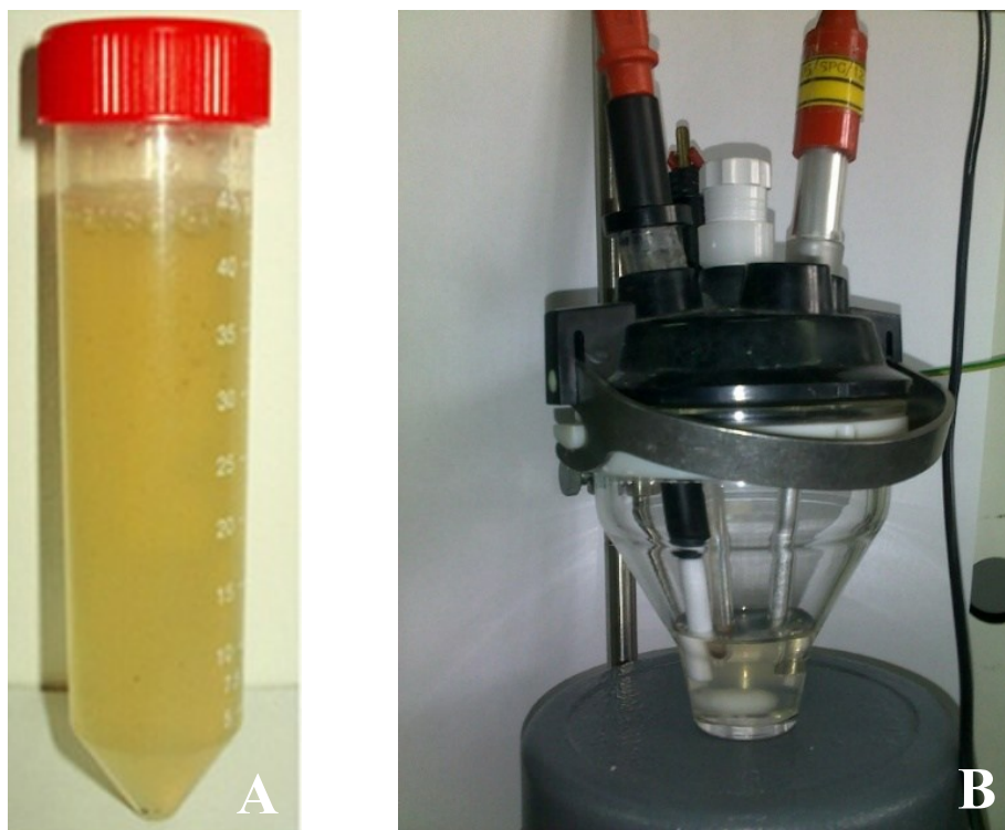
Slika 20. A) Nefiltrirani uzorak porne vode sedimenta Velikog Bačkog kanala koji je korišćen kao realni uzorak; B) Izgled voltametrijske ćelije sa dodatim realnim uzorkom.
