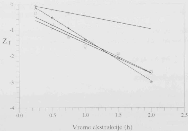
Slika 43. Zavisnost Z_T od vremena ekstrakcije timijana Eksperimentalne vrednosti: * - 80 bar; ★ - 150 bar; □ - 200 bar; × - 400 bar
