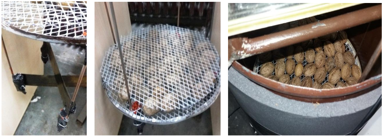
Slika 2-18. a) Stabilizacija pokretnog dijela postrojenja b) Pokretni dio postrojenja sa materijalom nakon pripreme; b) Uzorci u toku sušenja
