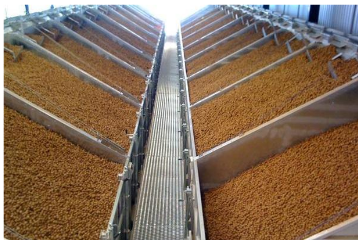
Slika 1-7. Postrojenje za sušenje sa nizom pregrada („bin“ sušare) napunjenih orasima [15]
