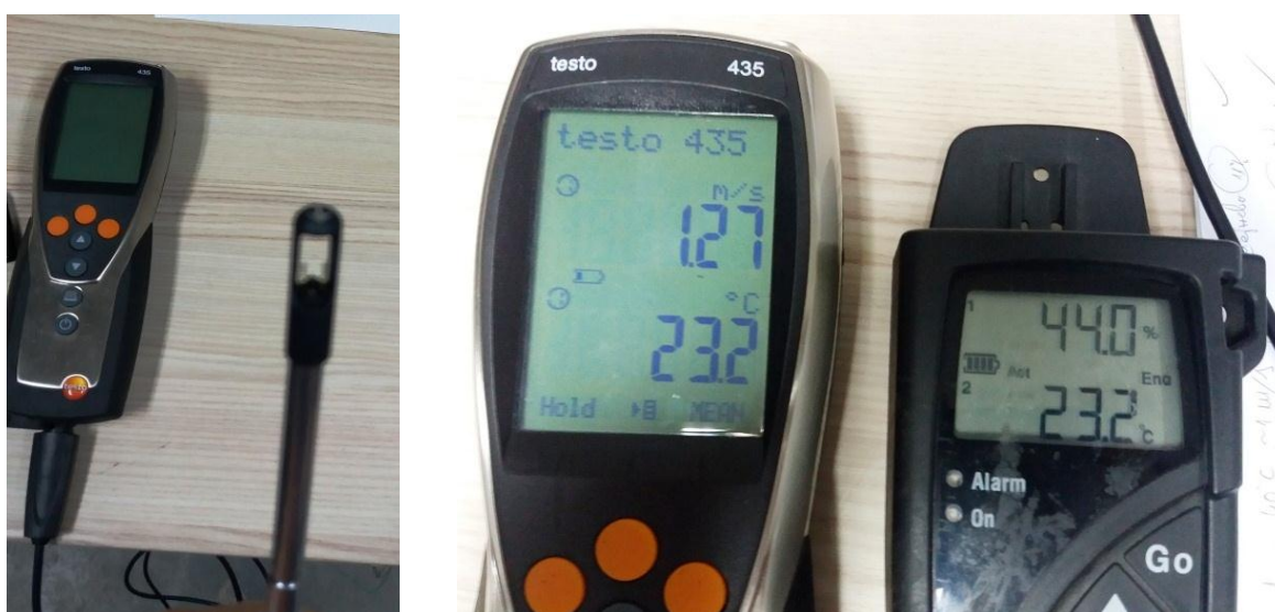
Slika 2-21. a) Termoanemometar i sonda sa toplim krajem; b) Termoanemometar i logger za relativnu vlažnost (na displeju se učitava ista temperatura vazduha čime se potvrđuje tačnost mjerenja)
