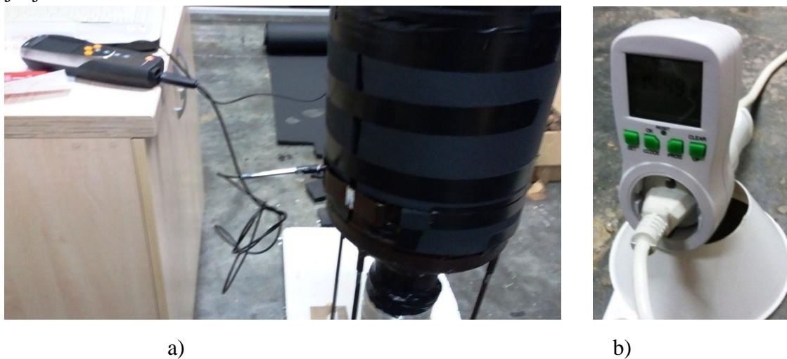
Slika 2-16. Priprema vazduha: a) Mjerenje temperature i brzine vazduha; b) Programabilni uređaj za prekid dovoda struje
