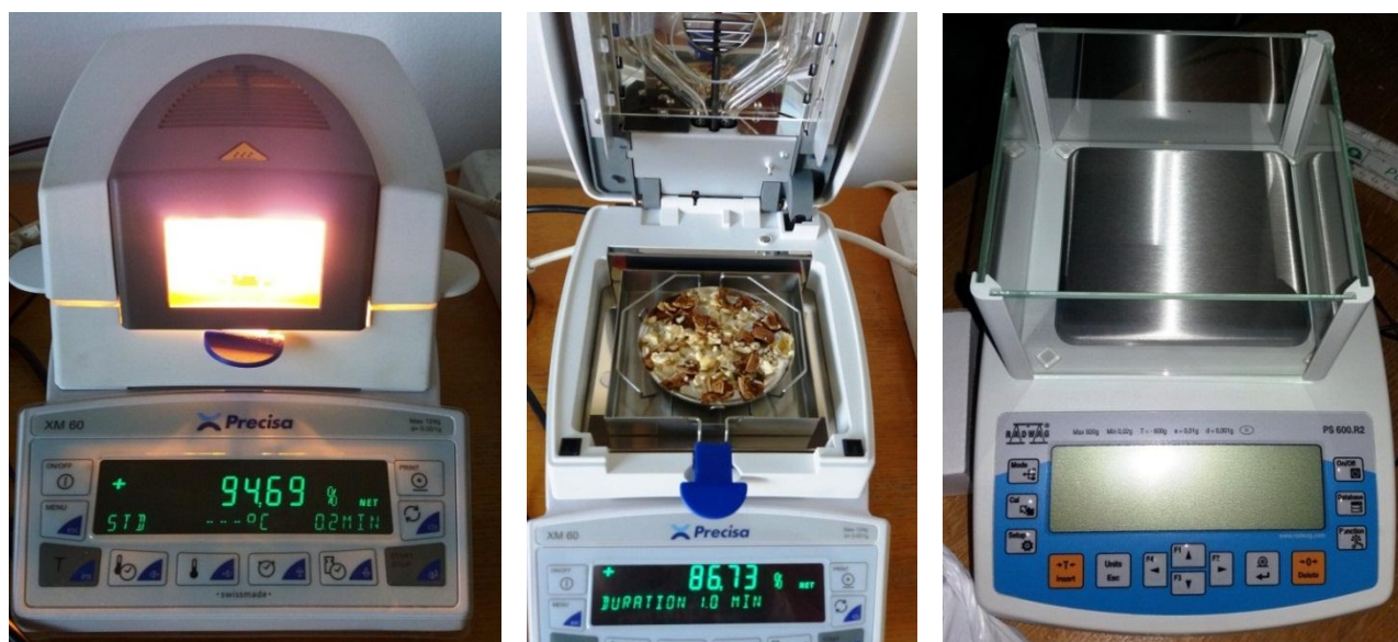
Slika 2-5. a) Uređaj „Precisa“ u radu; b) Uređaj „Precisa“ u pripremi sa usitnjenim materijalom; b) Precizna vaga „Radwag“
