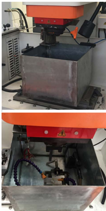
Slika 4-5. Kadica sa elementima za pričvršćivanje i pozicioniranje obratka
