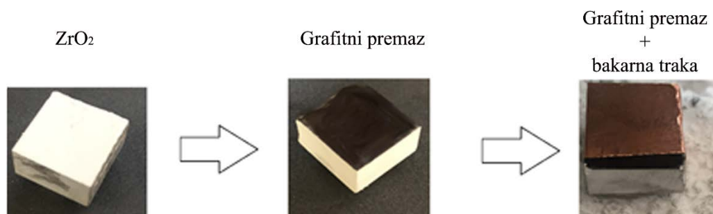
Slika 4-6. Proces postavljanja pomoćne elektrode na izolacionu keramiku
