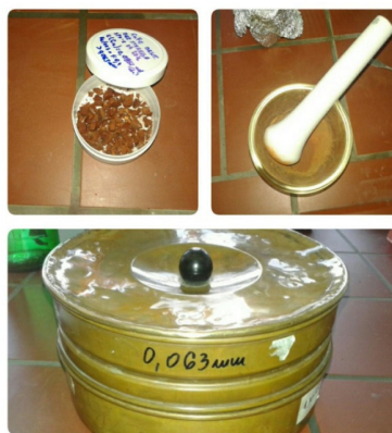
Slika 26. Separacija čestica katalizatora određene veličine
