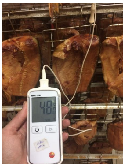
Slika 12. Kontrola temperature etalonskim termometrom u centru proizvoda
