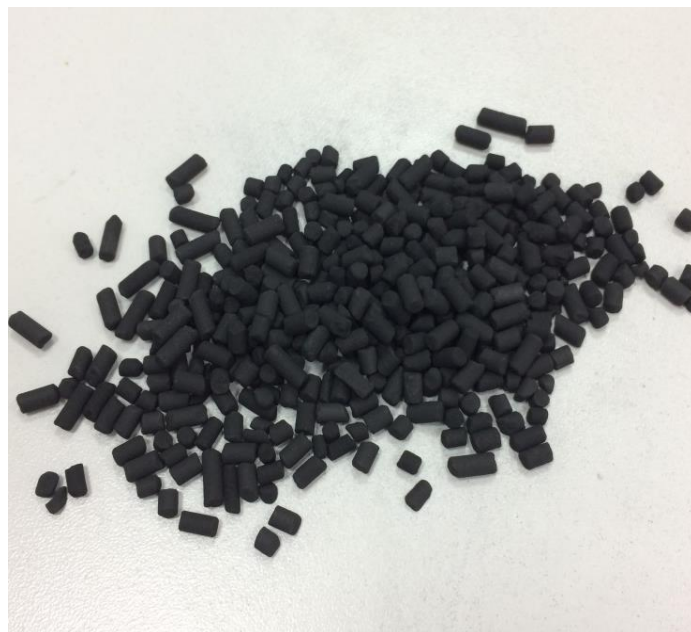
Slika 8. Granulirani aktivni ugalj
