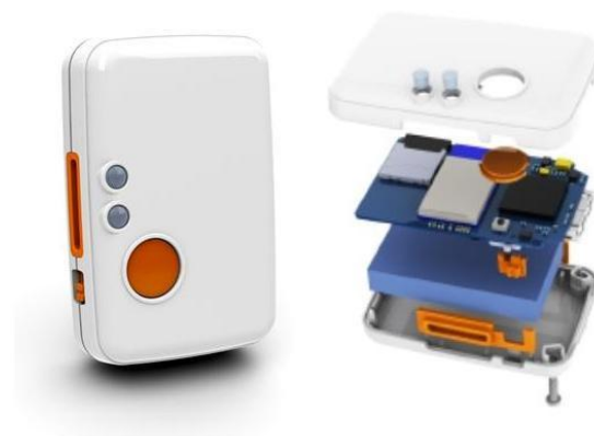
Slika 22. Tipični nosač senzora platforme Shimmer3 [38]
