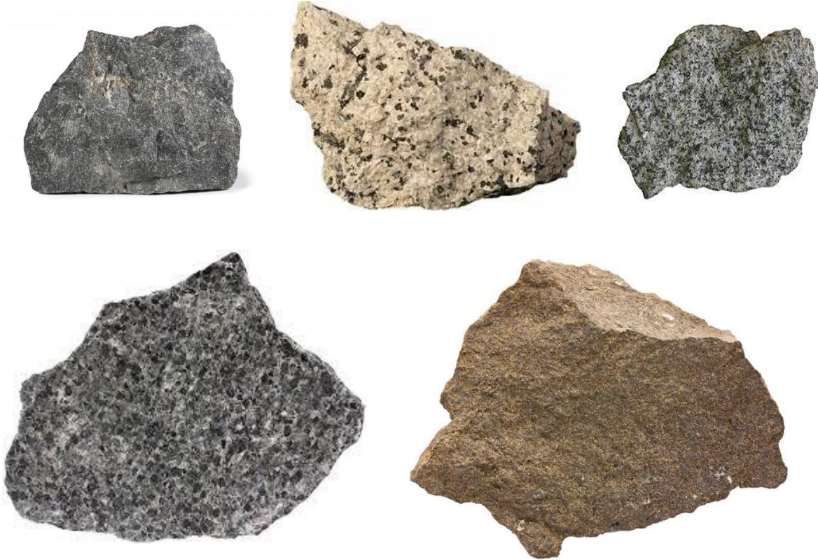
Слика 1. први ред: гранит, сијенит, диорит; други ред: габро, перидотит
