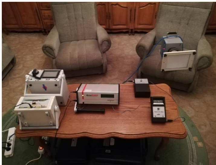
Slika 5.5. Eksperimentalna postavka pumpe velikog protoka i monitora SARAD (RTM1688-2 i RPM2200) kao i AlphaGuard monitora.
