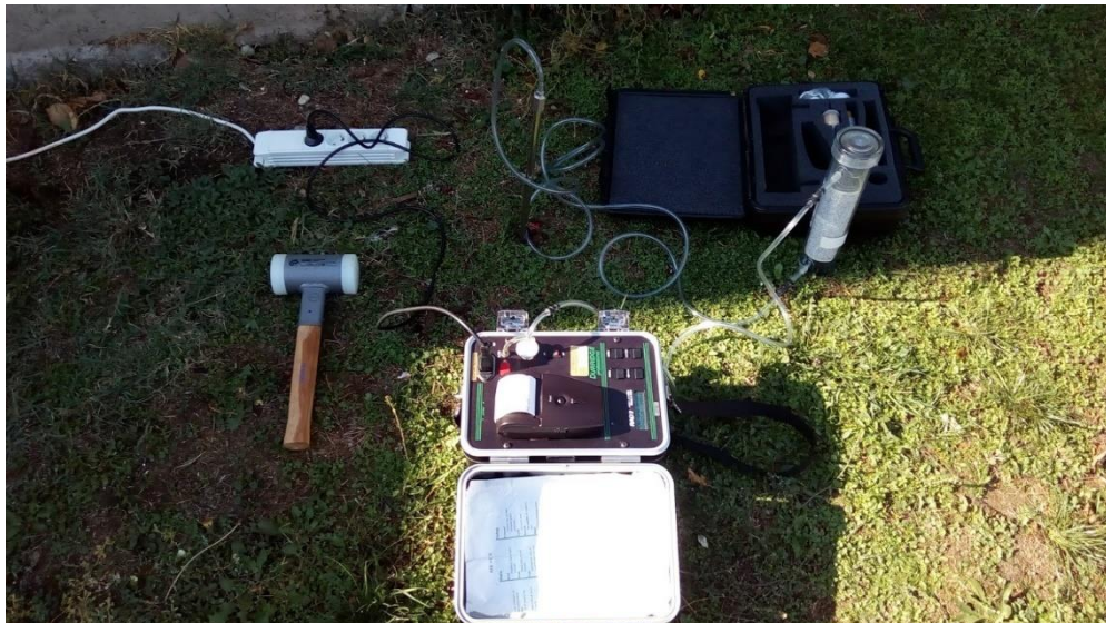
Slika 7.1. Eksperimentalna postavka RAD7 monitora za merenje koncentracije radona i torona u zemljištu, slika sa terena.
