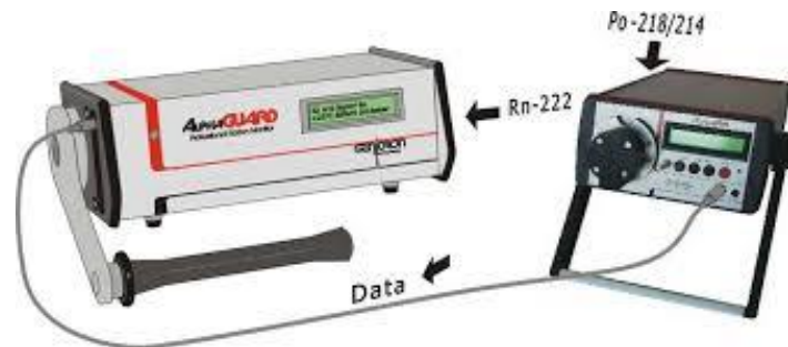
Slika 6.1. Šematski princip rada monitora AlphaGuard PQ2000 PRO sa dodatkom za merenje radonovih potomaka AlphaGuard PM.
