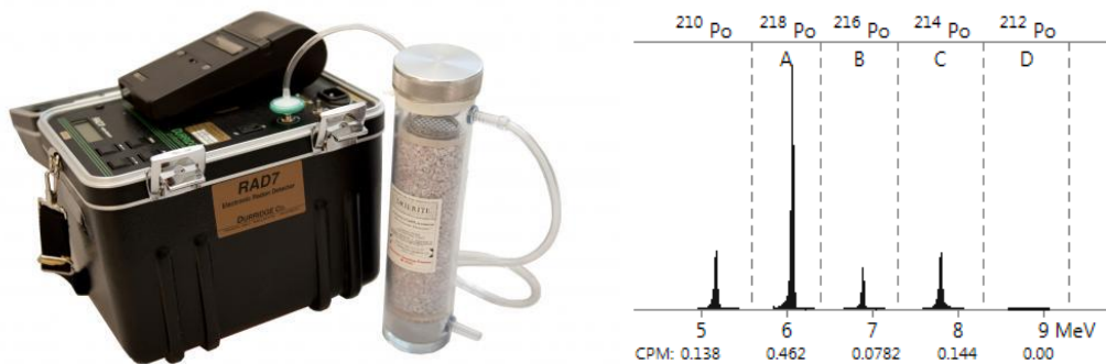
Slika 5.2. Ekperimentalna postavka aktivnog uređaja RAD7 za merenje koncentracije radona i torona u zatvorenim prostorijama (indoor) – levo i izgled alfa spektra - desno.
