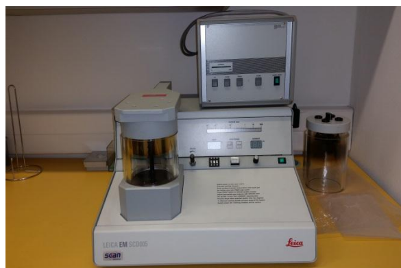
Слика 6.9 Уређај за напаривање узорка ( SCD050 Sputter Coater; LEICA, TO, Japan )
