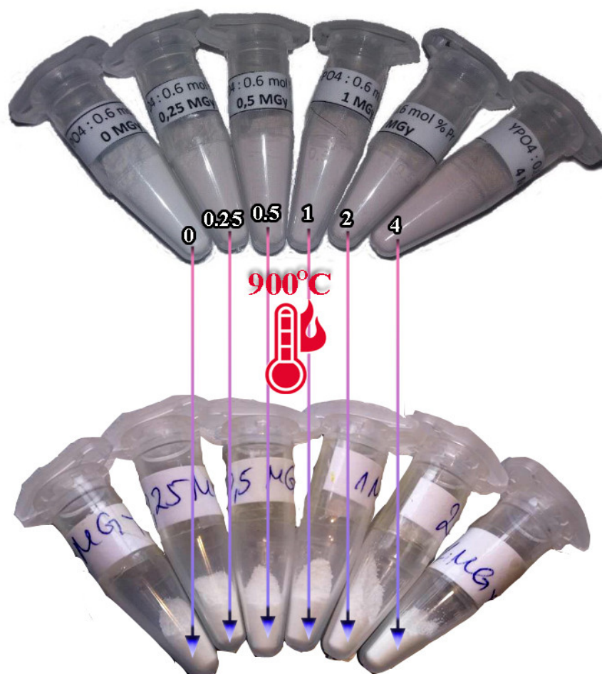
Slika 4.22. Promena boje uzoraka \text{YPO}_4:0,1 \text{ at\% Pr}^{3+} izloženih različitim dozama gama zračenja (0; 0,25; 0,5; 1; 2 i 4 MGy) i oporavak izazvan žarenjem od 900^\circ\text{C} u trajanju od 4 sata [261]
