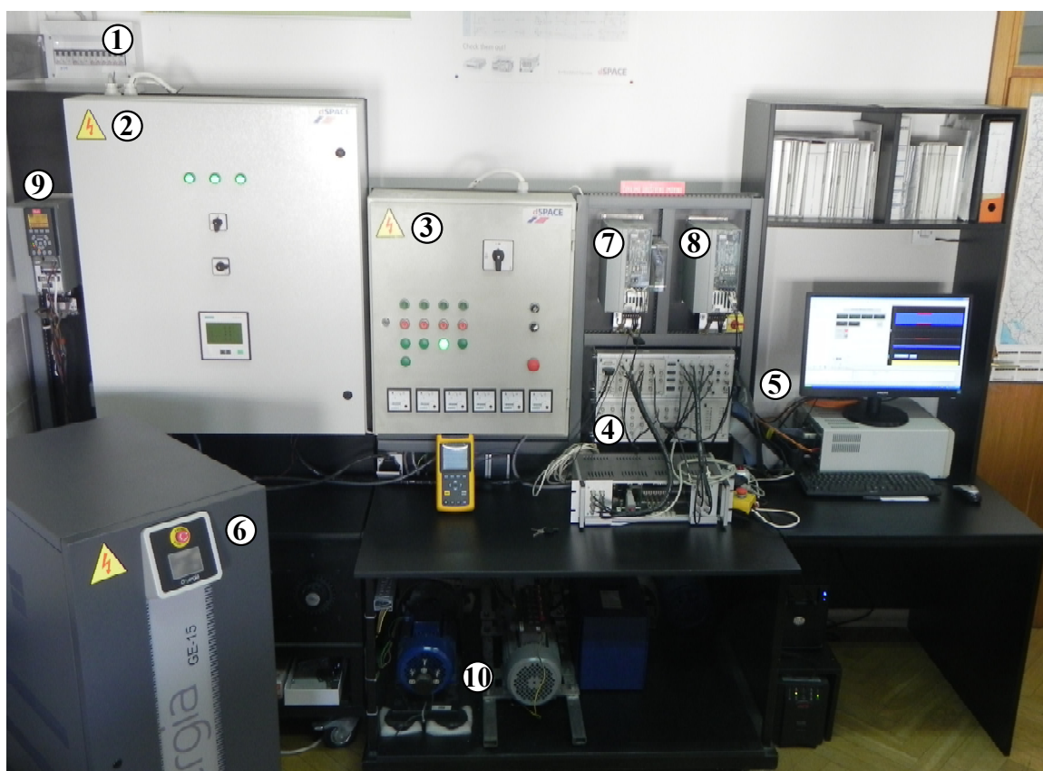
Slika 6.2 Savremena istraživačka stanica za ispitivanje pretvarača povezanog na elektroenergetski sistem pri različitim uslovima rada
