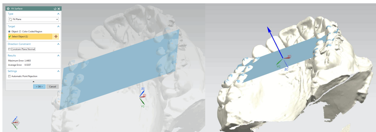
Slika 6.3.3. Treći korak, fitovanje ravni kroz centre kalota (sfere)
