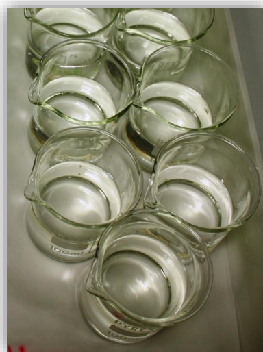
Slika 5. Eksperimentalna postavka ispitivanja akutne toksičnosti sa vrstom Daphnia magna
