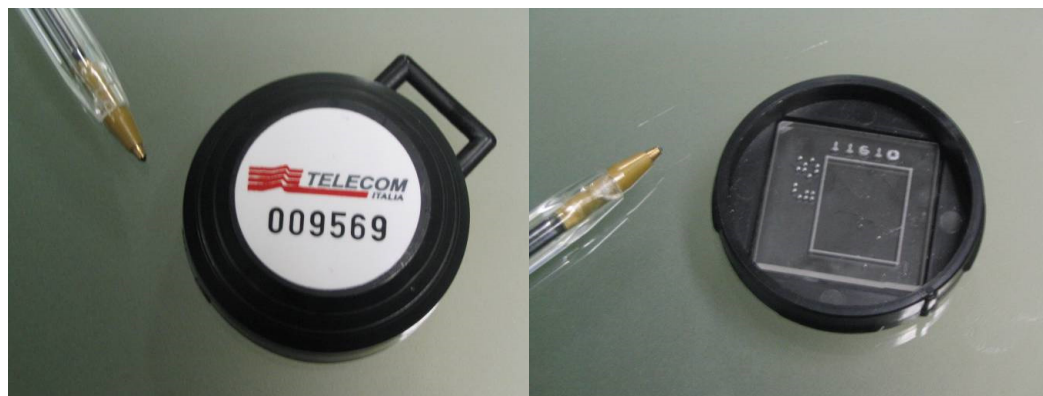
Слика 5.1. Изглед дифузионе коморе RSKS са CR-39 детектором на дну
