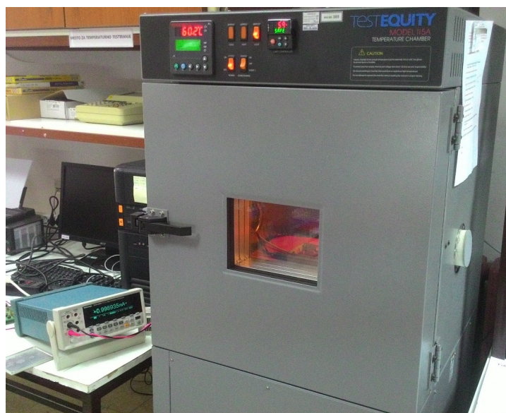
Slika 5.33 Testiranje realizovanog sistema pri promenljivoj ambijentalnoj temperaturi
