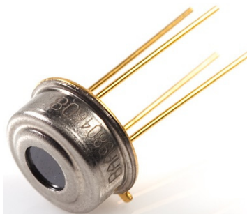
Slika 3.11 Izgled tipičnog temperaturnog senzora IR zračenja
