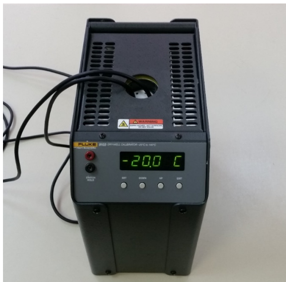
Slika 5.10 Merna postavka provere tačnosti merenja dva senzora DS18B20
