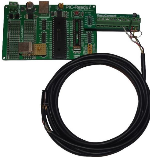
Slika 5.41 Izgled realizovanog sistema zasnovanog na senzoru MLX90614
