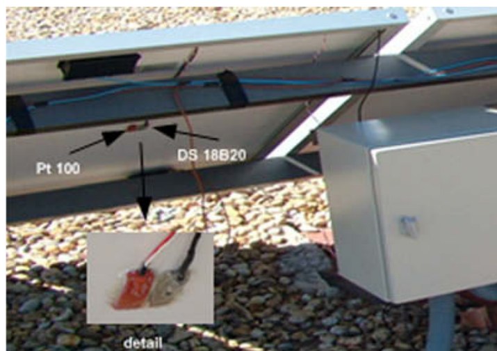
Slika 4.14 Montaža senzora u radu [69]
