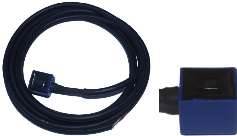
Slika 5.22 Izgled realizovane temperaturne sonde zasnovane na senzoru DS18B20
