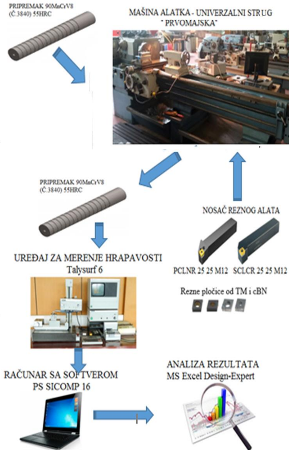
Slika 69. Šema merenje parametara hrapavosti obrađene površine u procesu struganja
