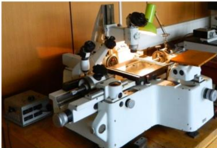
Slika 64. Univerzalni merni mikroskop UIM – 21
