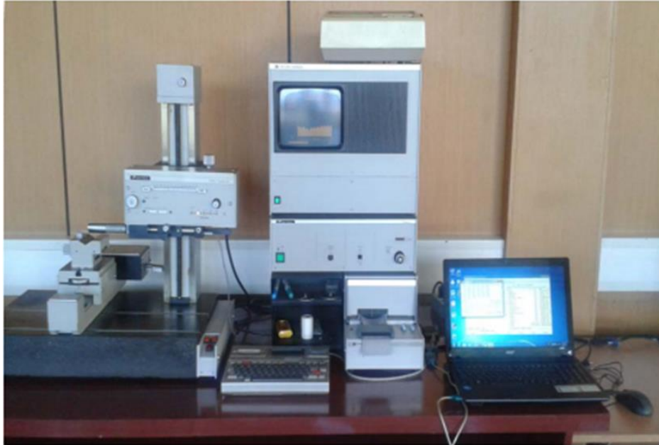
Slika 55. Merni sistem za Talysurf-6 povezan sa računarom i primer merenja
