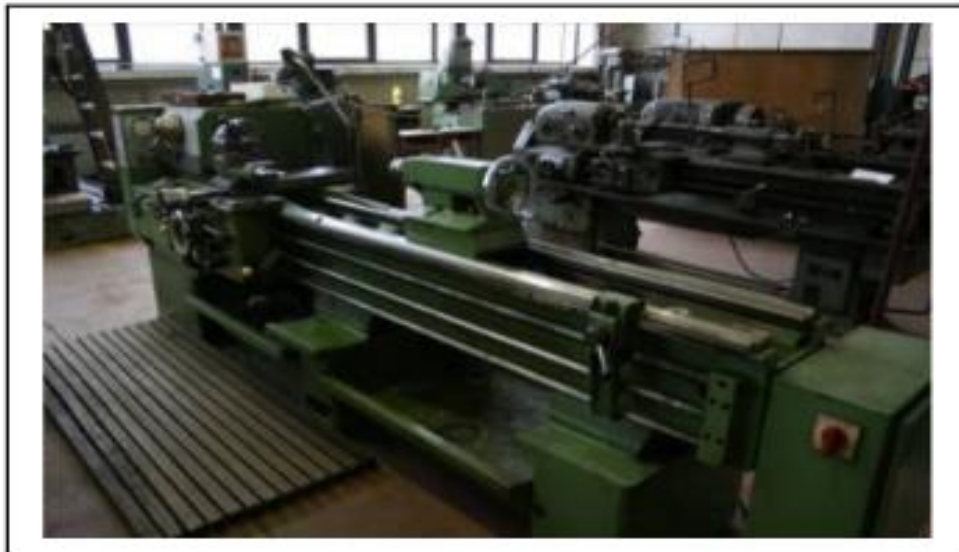
Slika 51. Univerzalni strug – Prvomajska DK480
