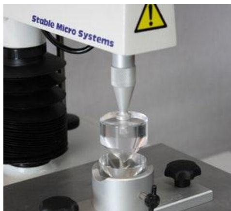
Slika 9. Analizator teksture TA-XTPlus Texture Analyzer TA.XT2 sa konusnim priborom
