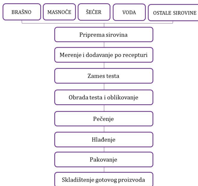
Slika 4. Tehnološki postupak proizvodnje čajnog peciva
