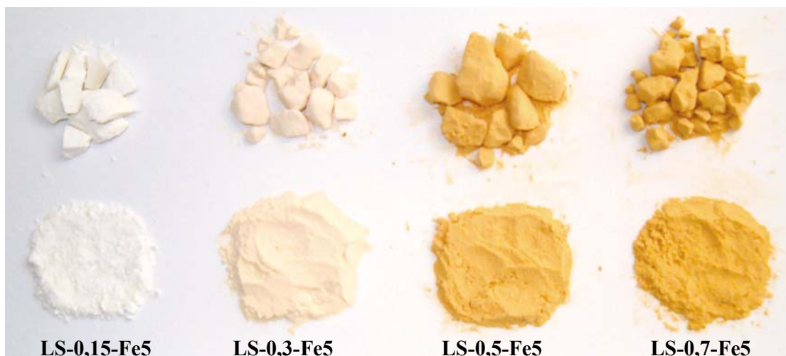
Slika 14. Fotografija Mg-Al-Fe uzoraka: nakon LS sinteze i sušenja (gornji red) i nakon sprašivanja (donji red)
