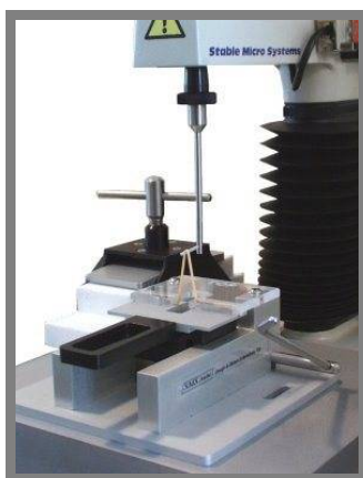
Slika 3.5 Određivanje rastegljivosti testa metodom po Kieffer-u
