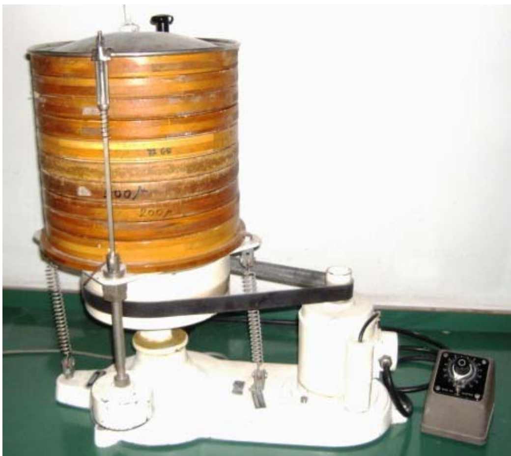
Sl. 24 – Laboratorijsko sito – model MLU-300, Bühler
