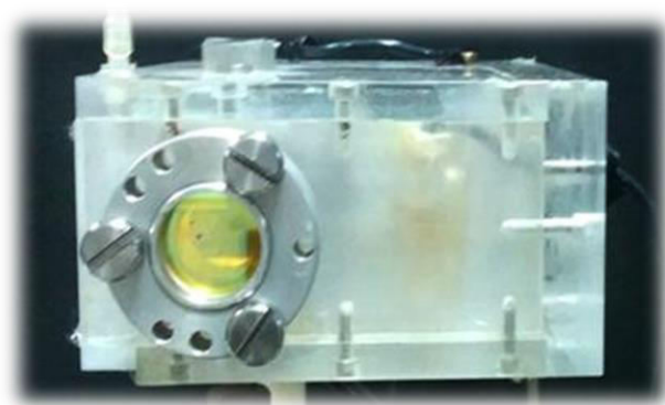
Slika 3.6. Levo: Fotografija TEA CO 2 lasera; desno: vremenska evolucija intenziteta TEA CO 2 laserskog impulsa
