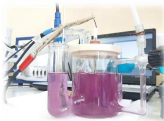
Slika 3.5. Šema troelektrodne ćelije i uređaja za snimanje I-E krivih (levo) i fotografija troelektrodne ćelije korišćene u ovom radu (desno)
