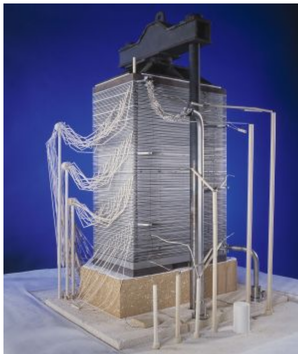
Slika 2.1.3: Povezivanje gorivnih ćelija u stak
