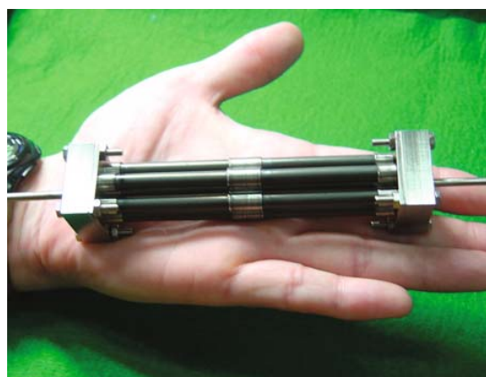
(b) Mikro-stak od 14 gorivnih ćelija
