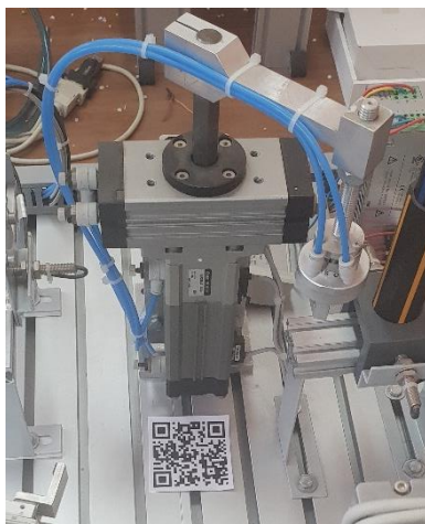
Slika 4-15 Pneumatski cilindar sa markerom u vidu QR koda
