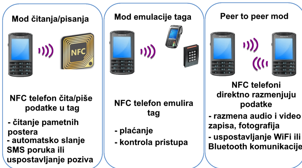
Slika 2-29 Mobilni telefon sa NFC tehnologijom i sva tri moda rada
