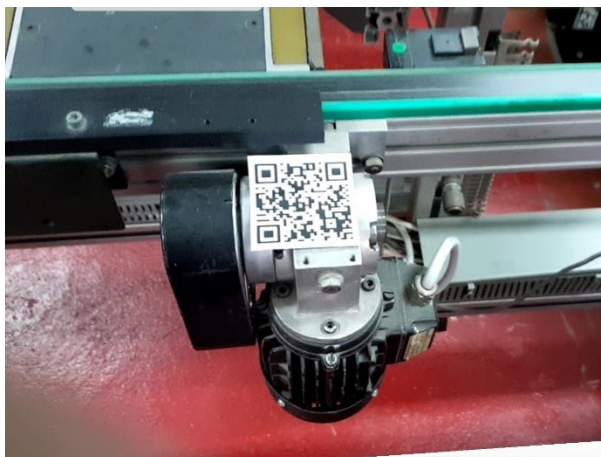
Slika 4-20 Trofazni asinhroni motor sa markerom u vidu QR koda
