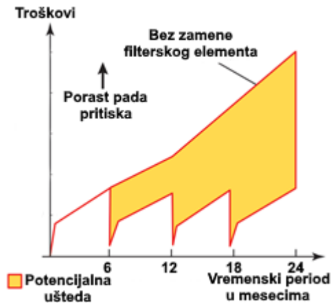
Slika 4-6 Ušteda koja se postiže redovnom zamenom filterskog elementa
