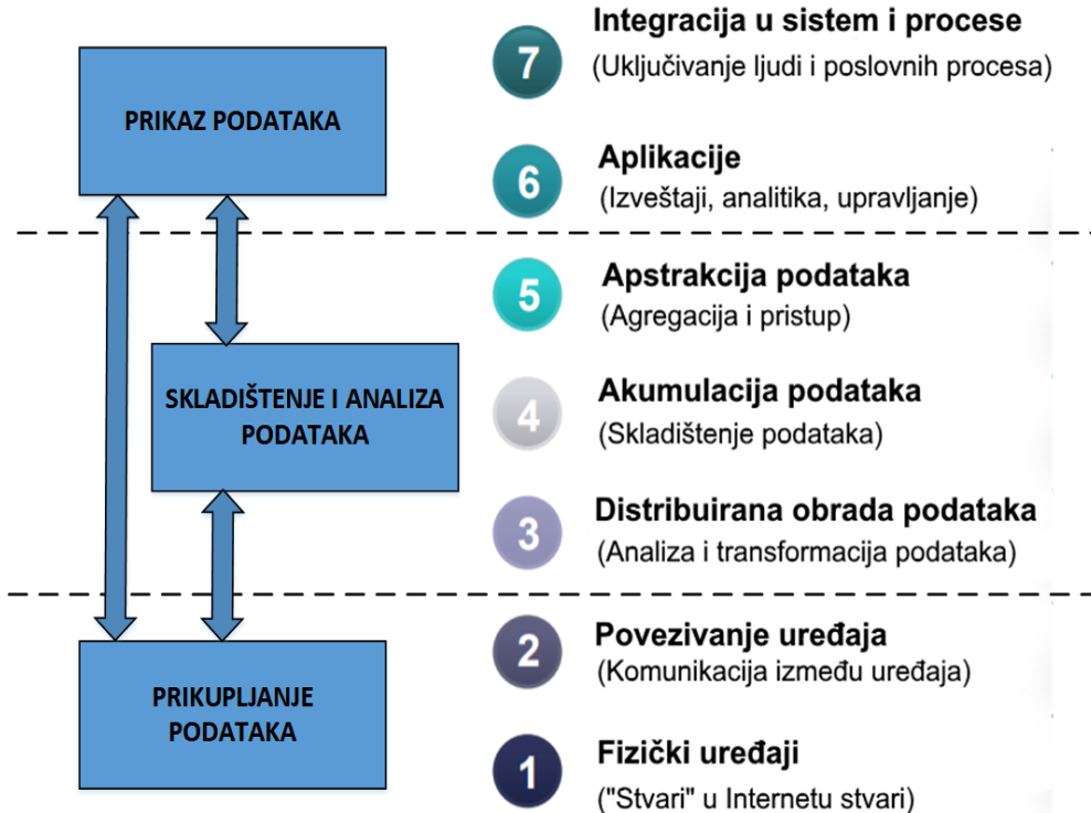
Slika 3-2 Uporedni prikaz predloženog modela mobilnog nadzornog sistema sa proširenom realnošću i integrisanim industrijskim Internetom stvari i referentnog modela Interneta stvari
