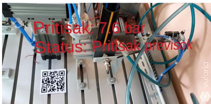
Slika 4-17 Previsok pritisak u pneumatskom cilindru
