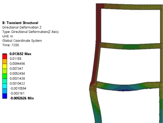
a) Deformacija nosača nakon 2h požara - Z pravac
