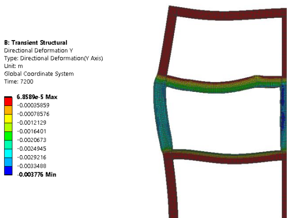
a) Deformacija nosača nakon 2h požara - Y pravac
