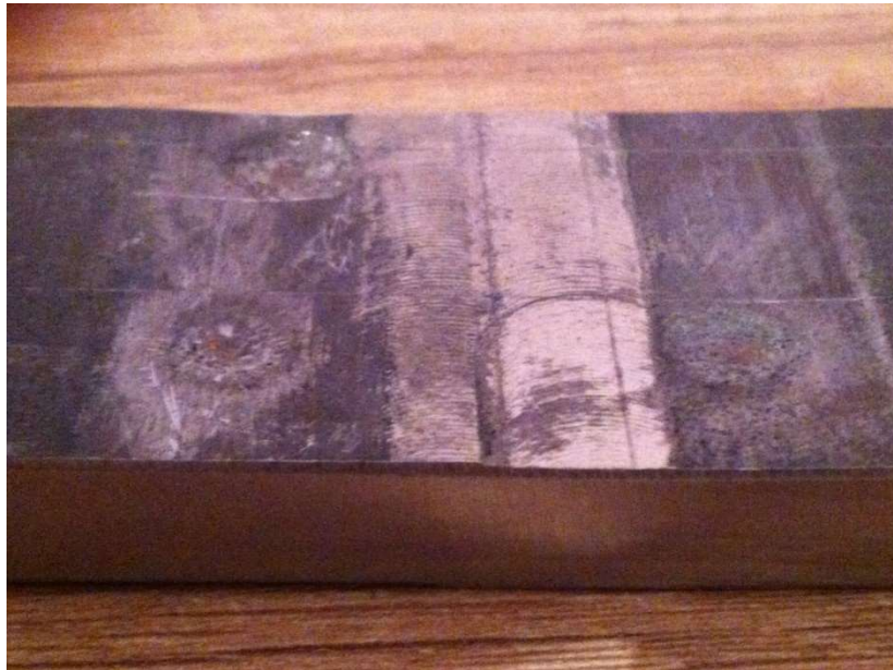
Slika 4.64. Oštećenje u oblasti osnovnog materijala: leva strana zador (hitac 7 i 8); desna strana zador (hitac 9).
