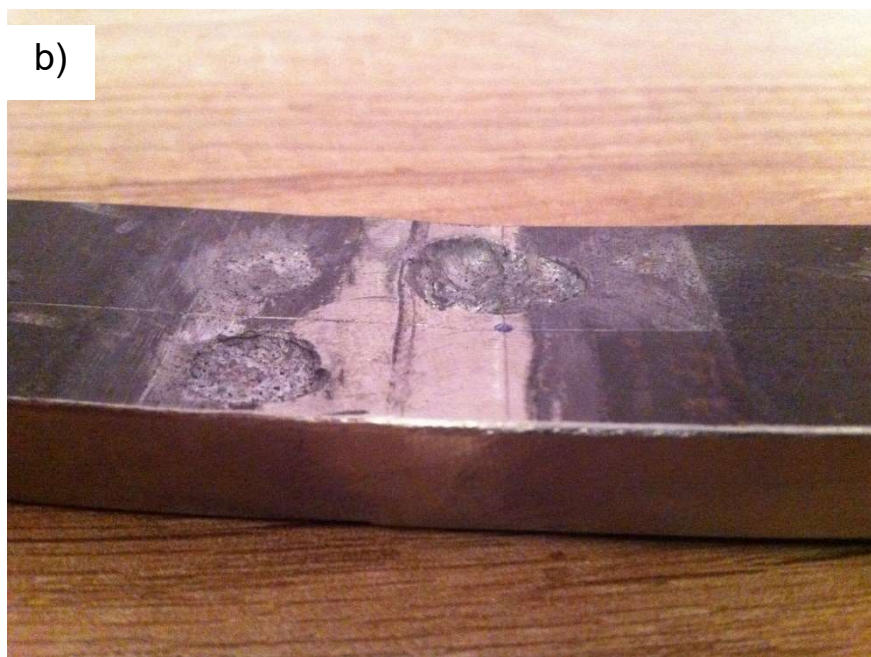
Slika 4.63. Oštećenje u oblasti ZUT-a: a) leva strana zador sa prslinom (hitac 4 i 5); b) desna strana zador krenuo čep (hitac 6).
