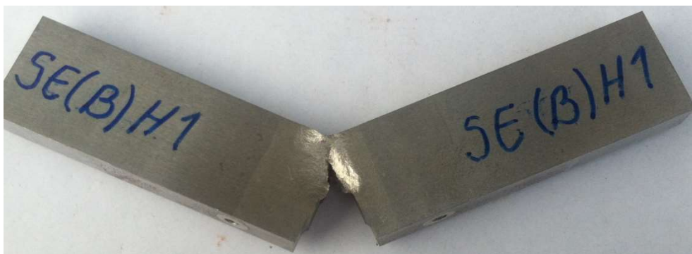
Slika 4.42. Prelomljena epruveta sa zarezom u ZUT kod epruvete ispitane mehanikom loma.
