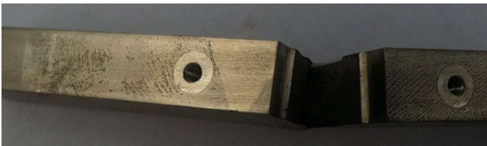
Slika 4.43. Prelomljena epruveta sa zarezom u ZUT/metal šavu kod epruvete ispitane mehanikom loma.
