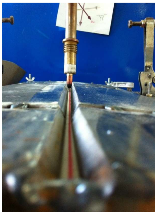
Slika 3.7. b) Pozicioniranje pištolja sa prikazom postavljene keramičke podloške.
