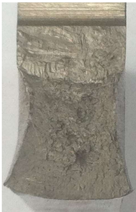
Slika 4.35. Slika površine preloma nakon ispitivanja mehanike loma za prslinu u osnovnom materijalu.
