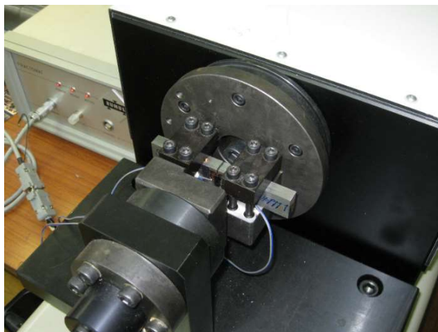
Slika 3.27. Visokofrekventni pulzator za stvaranje i propagaciju prsline kao i uređaj za merenje dužine prsline Fractomat.
