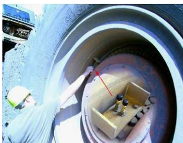
Slika 20. Poklopci ventila - senzori za nadzor pritiska vazduha u pneumaticima teretnih vozila [16]
