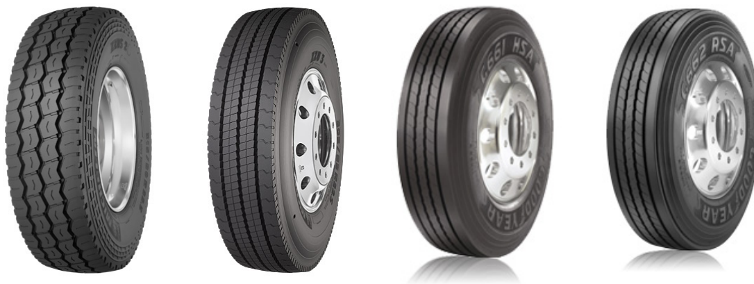
Slika 10. Dezeni protektora pneumatika za autobuse za međumesni saobraćaj [15]
