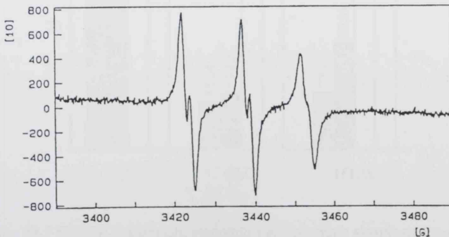
Slika 42. ESR spektar PBN-OOLM spin-adukata nastalih tokom katalitičke oksidacije metil-linoleata u model sistemu II u prisustvu 0.02% etil-acetatnog ekstrakta hidrotermički tretiranog zrna soje
