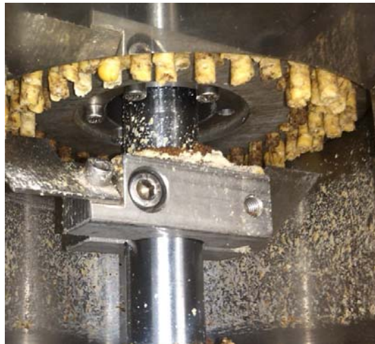
Slika 19. Odsecanje peleta na željenu dužinu.
