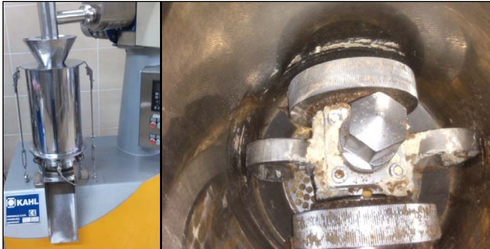
Slika 18. Pelet presa sa ravnom matricom.
