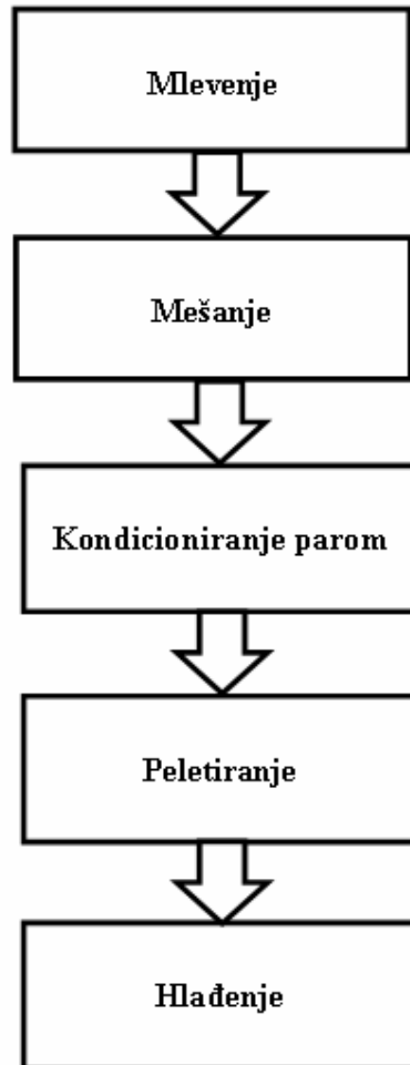
Slika 14. Šematski prikaz linije za proizvodnju peleta.
