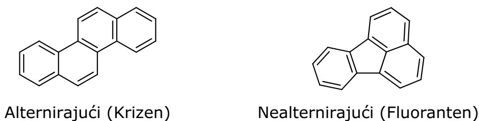
Slika 2.2 Primer alternirajuće i nealternirajuće strukture
