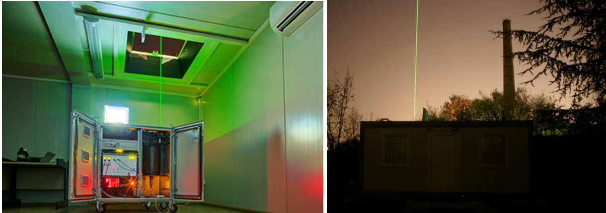
Slika 4.3.4. Lidar sistem korišćen za određivanje vertikalnih profila atmosfere
