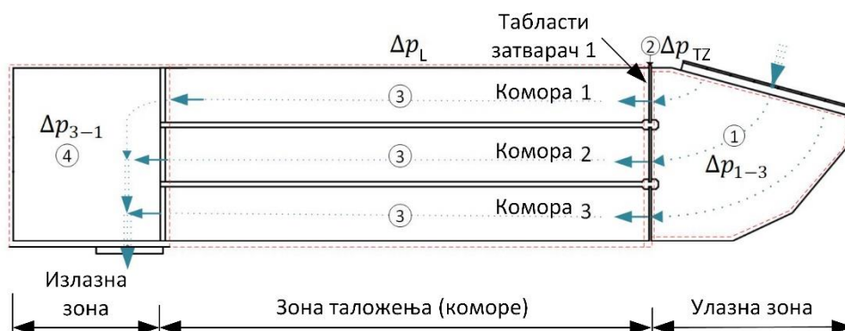
Слика 5.58 | Падови притисака услед локалних и подужних отпора у таложнику.
