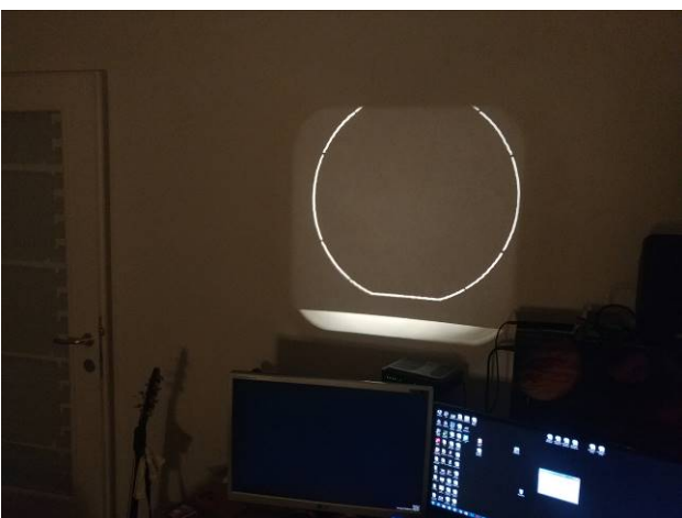
Slika 35: Test oštrote i hromatske aberacije sa lasera
