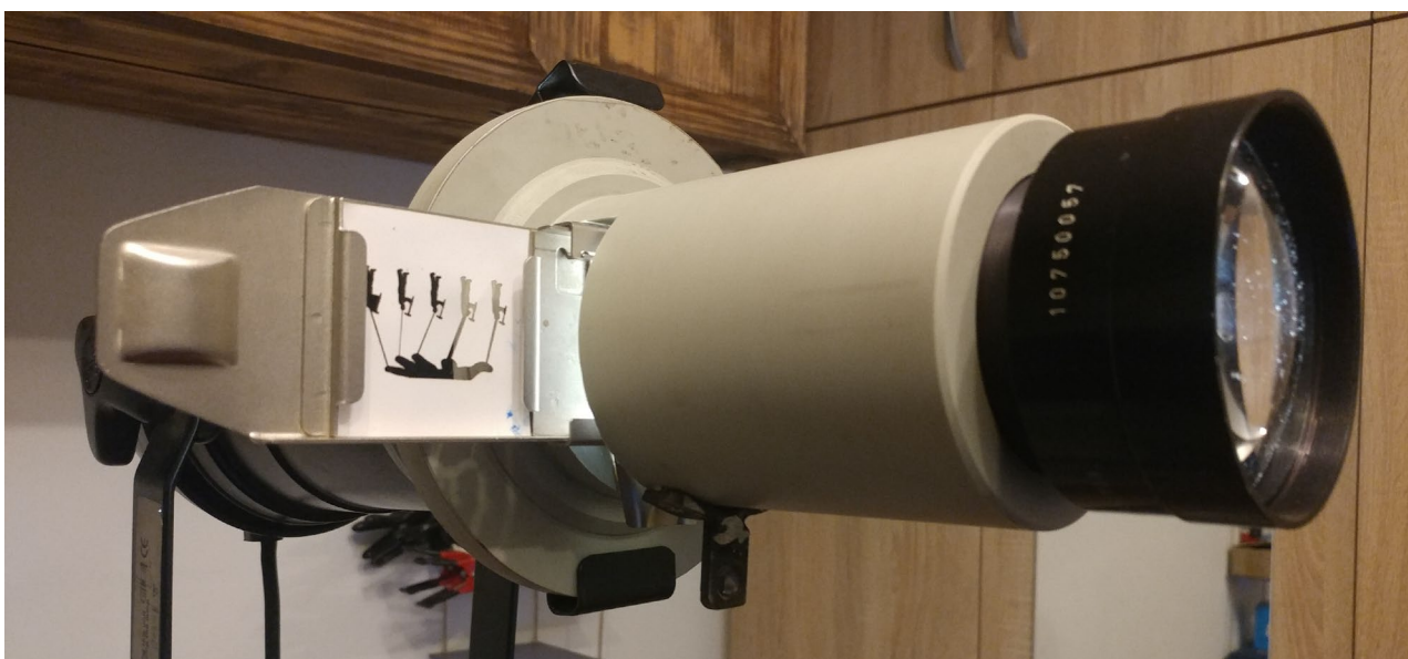
Slika 11: Konačna konstrukcija za rad sa goboima. Nazad lijevo: LED rasvjetno tijelo; u sredini metalni ram za postavljanje goboa na plastičnoj konstrukciji za nošenje ovoga i sočiva; naprijed desno: objektiv za filmski projektor koji se fokusira laganim pokretanjem naprijed-nazad
