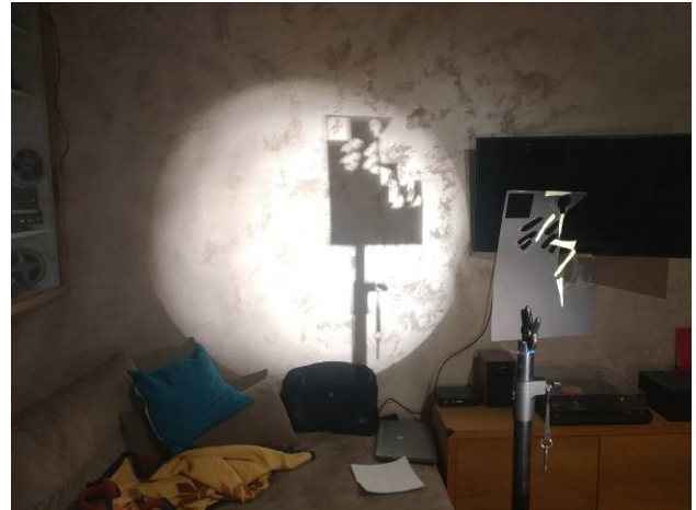
Slika 75: Testiranje oštine fresnel rasvjetnog tijela
