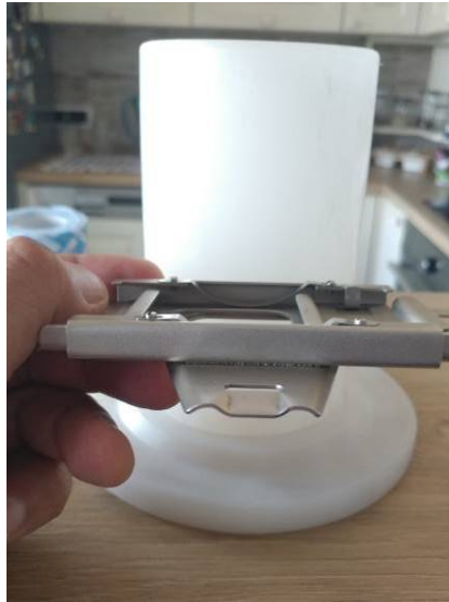
Slika 51: Žlijeb za nosač goboa
