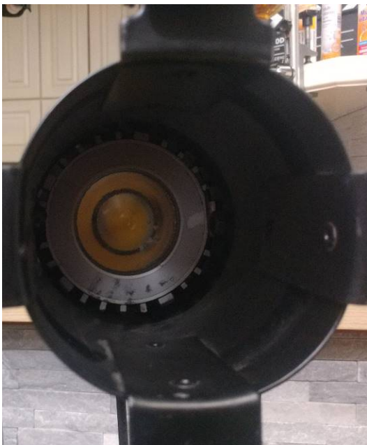
Slika 78: Izgled COB LED rasvjetnog tijela
