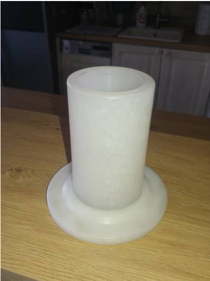
Slika 50: Nosač izraden na CNC mašini
