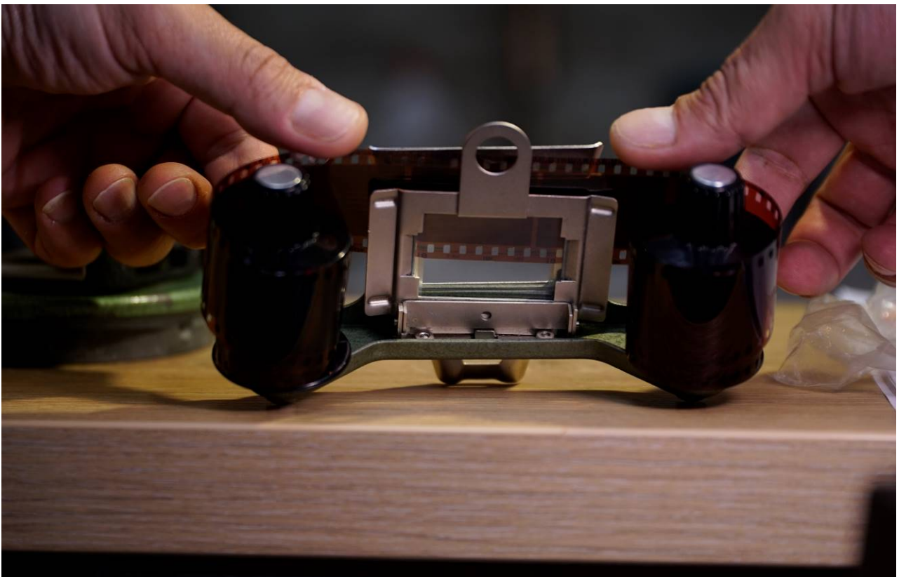
Slika 113: Postavljenje filma u ležište nosača
