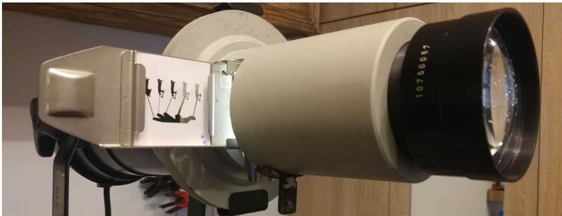
Slika 57: konstrukcija sa izrađenim ležištem i ubačenim nosačem goboa
