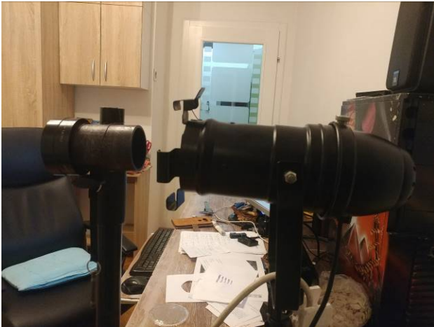
Slika 48: Postavljanje sočiva ispred rasvjetnog tijela
