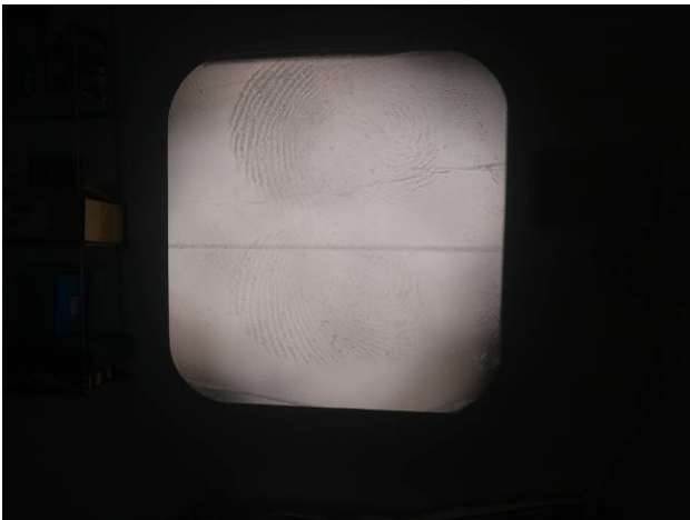
Slika 33: Testiranje oštrote projekcije sa selotejpom
