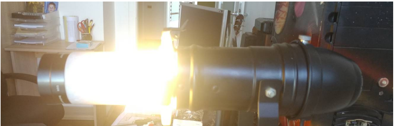
Slika 56: Upaljeno rasvjetno tijelo, nakon čega je utvrđeno da konstrukcija mora da se farba iznutra zbog rasipanja svjetla
