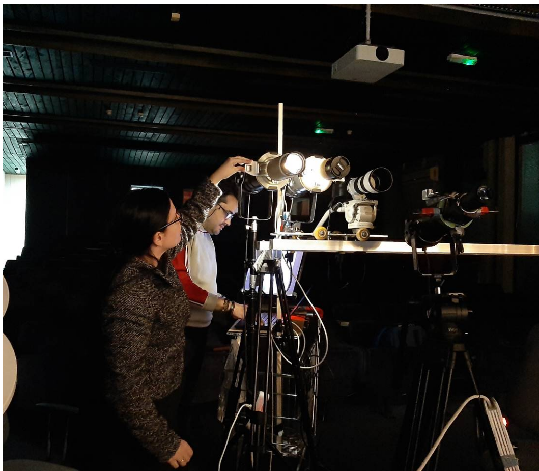
Slika 102: Snimanje: 1. Promjena goba; 2. tehnika – tri projektora goba (dva u sredini i jedan desno), kamera na faru (izmenju projektora goba), filmski projektor (gore desno iza) i laptop i monitor (u sredini iza)
