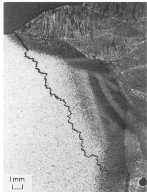
Slika 11. Zaključci vizuelnog pregleda loma površine kao i putanje loma i lokacije crnih depozita (šrafirana površina), levo; presek kroz zavar 2/3, HAZ2, koji pokazuje karakteristično ravno pucanje kroz ZUT, koje je potom praćeno cik cak putanjom kroz osnovni materijal, desno [32]
