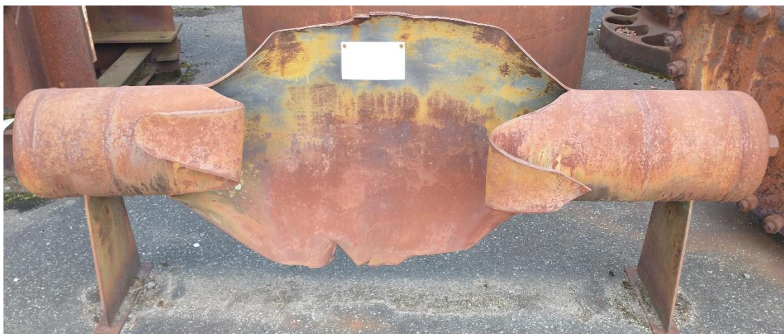
Slika 24. Primer niskotemperaturnog katastrofalnog otkaza manje posude pod pritiskom prilikom ispitivanja sa vazduhom
