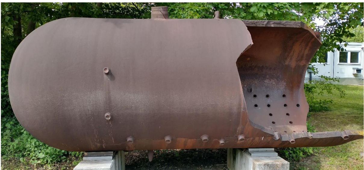
Slika 23. Klasičan primer krtog loma posude pod pritiskom prilikom hidroispitivanja
