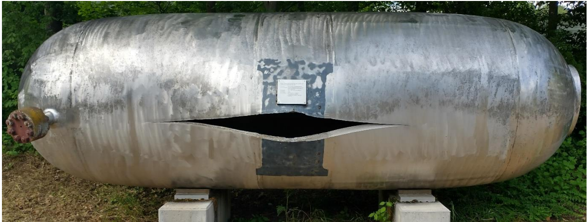
Slika 22. Primer otkaza posude pod pritiskom prilikom hidroispitivanja
