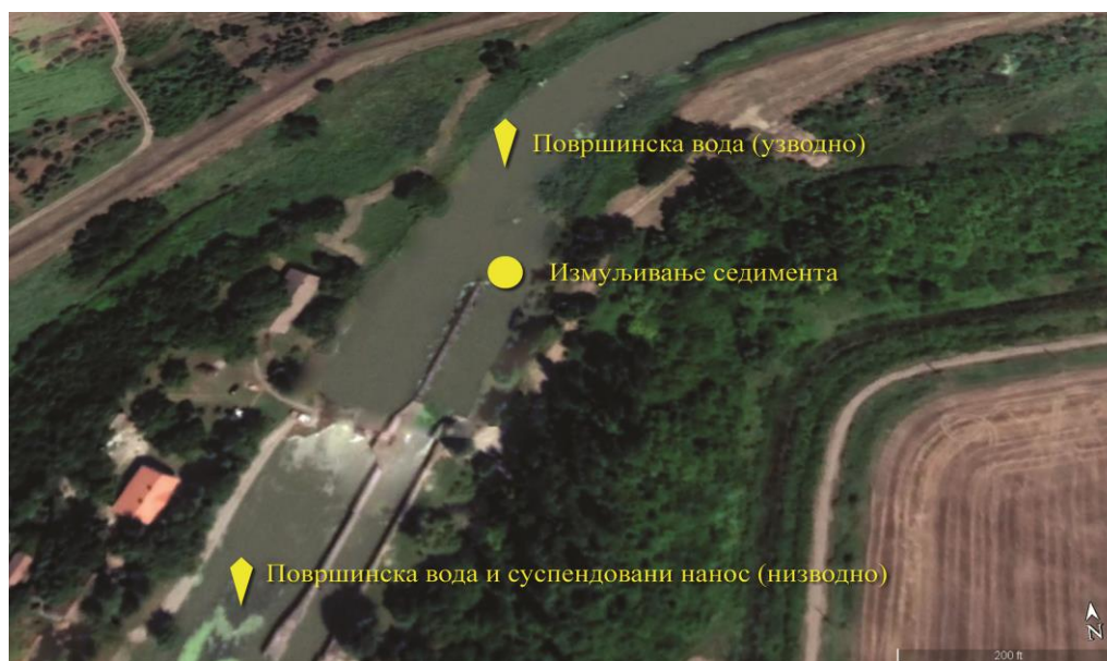
Слика 15. Профили површинских вода (узводно/низводно) и суспендованог наноса низводно од активности измуљивања
