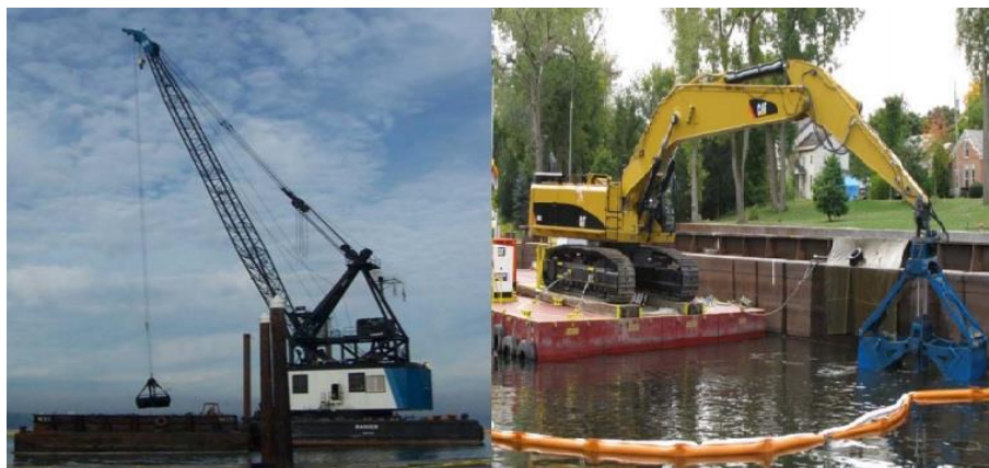
Слика 4. Мехнички багер са жичаном (лево) и зглобном (десно) кашиком (Fuglevand and Webb, 2012)
